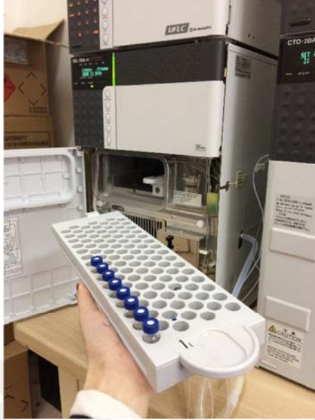
Şekil 3.16 Enjeksiyon ünitesine yerleştirilmiş ceviz numunelerinden bir görünüm
