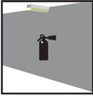
Tüm yangın söndürme ve- yangın alarm cihazları civarında
