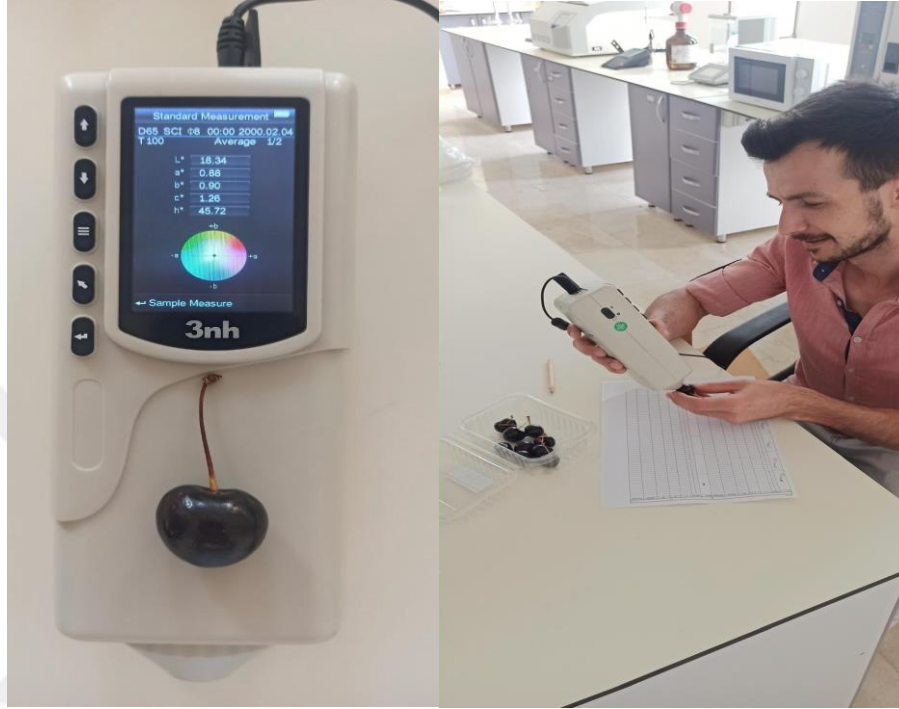
Fotoğraf 2.7. El tipi kolorimetre kullanılarak kiraz meyvesinin renk ölçümlerinin yapılması.
