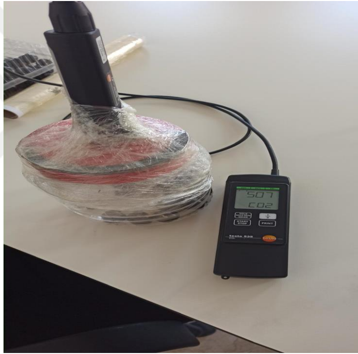
Fotoğraf 2.4. Testo 535 CO 2 ölçüm cihazı kullanılarak solunum ölçümü yapılması.
