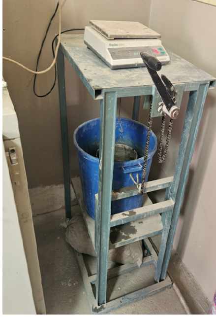
Şekil 4.8: Özgül ağırlık-yoğunluk tartı deney düzeneği
