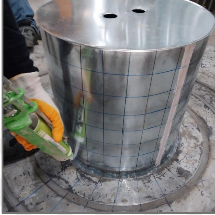
Şekil 3.5. Deneye hazırlanan numunenin silikon ile sabitlenmesi
