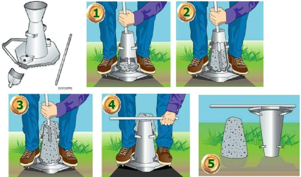
Şekil 7. Slamp ölçümünün şematik gösterimi (URL-3, 2024)
