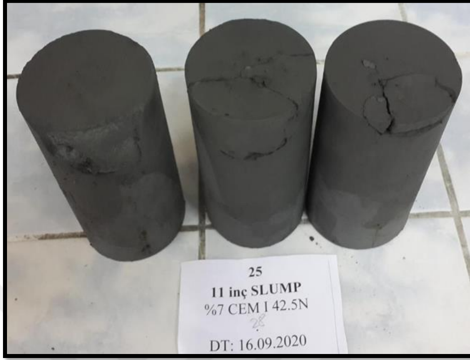
Şekil 21. 11" slump değerinde hazırlanan 28 günlük numunelerin kırılmadan önceki durumları (numuneler oldukça zayıf)
