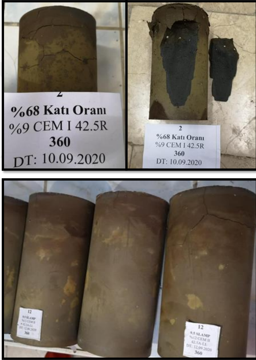
Şekil 22. 360 günlük kür süresi sonunda bazı numunelerde oluşan çatlamların yakın görünüşü
