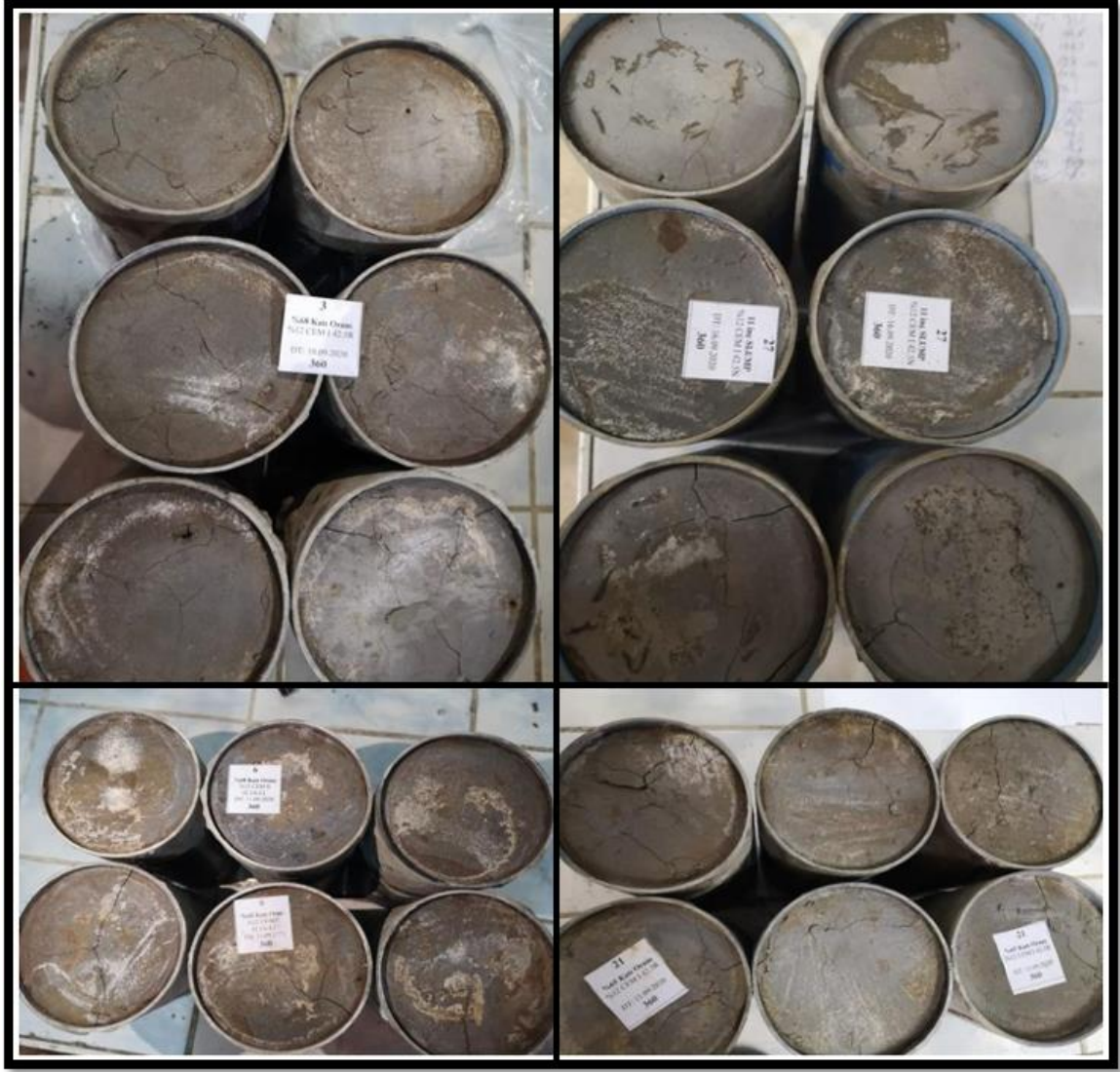
Şekil 23. 360 günlük kür süresi sonunda bazı numunelerin üst yüzeyinde oluşan çatlamlar
