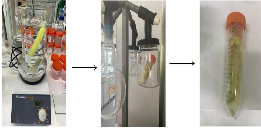
Şekil 3.4 q-(GTMAC-CS)'nin hazırlanmasına ait diyaliz ve liyofilizatörde kurutma süreci
