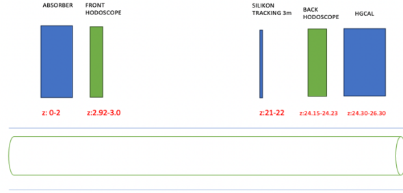
Şekil 3. 1: Basitleştirilmiş Pre-FACET geometrisinin iki boyutta çizimi.
