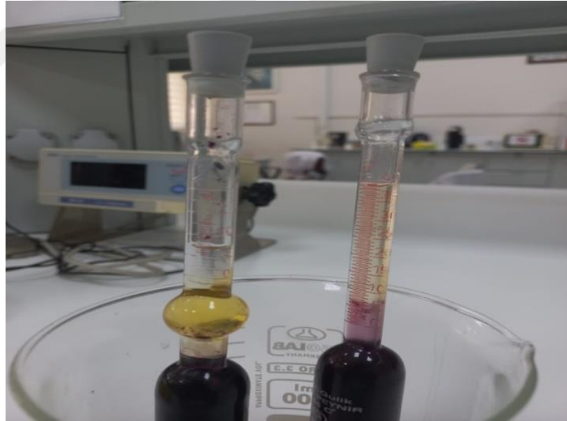
Şekil 2.2. Yağ tayini için santrifüjden çıkan numuneler
