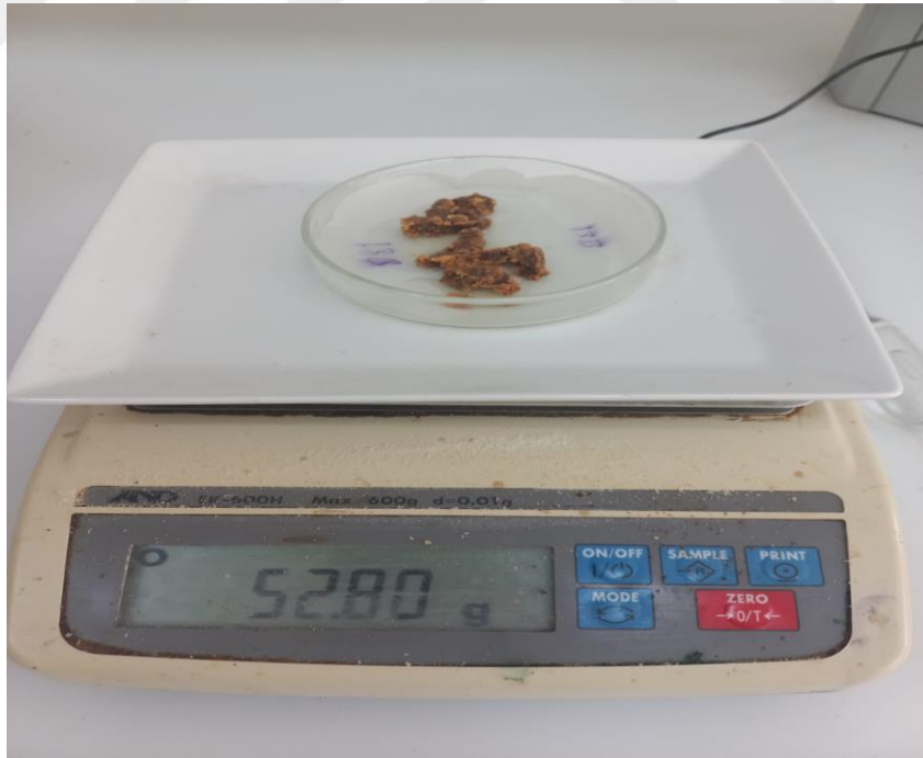
Şekil 2.1. Kuru madde tayini için etüvden çıkarılan numune.
