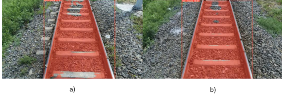
Şekil 5.58. (a) YOLOv7 ve (b) YOLOv8 modellerinin gerçek saha ortamındaki test sonuçları
