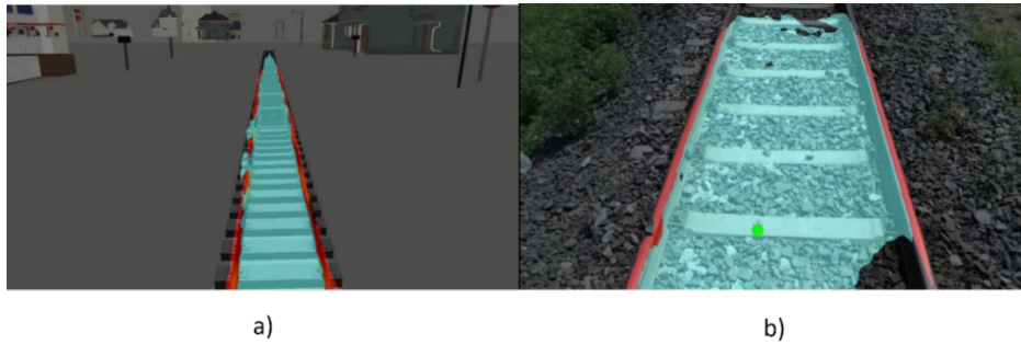
Şekil 5.57. BiSeNetV2 modelinin (a) simülasyon ve (b) gerçek saha ortamlarındaki test sonuçları
