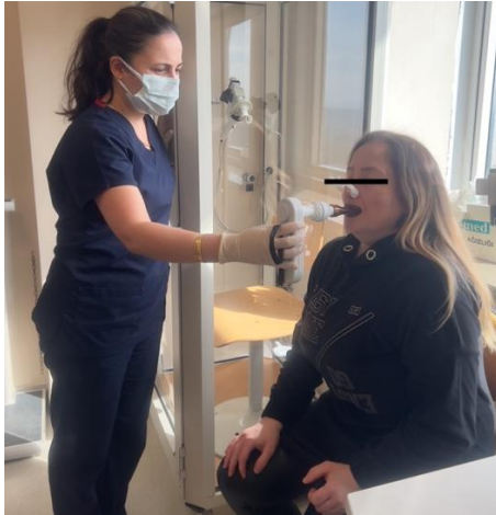
Şekil 2. MİP ve MEP Ölçümü, Micro-RPM® ağız içi basınç ölçüm cihazı
