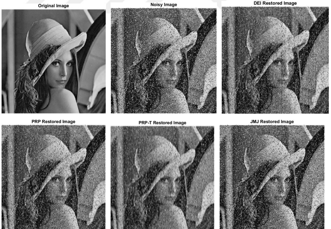
Şekil 5.4: %15 gürültü ile bozulmuş gürültülü Lena görüntüsü için DEI, PRP, PRP-T ve JMJ algoritması ile elde edilen restorasyon.
