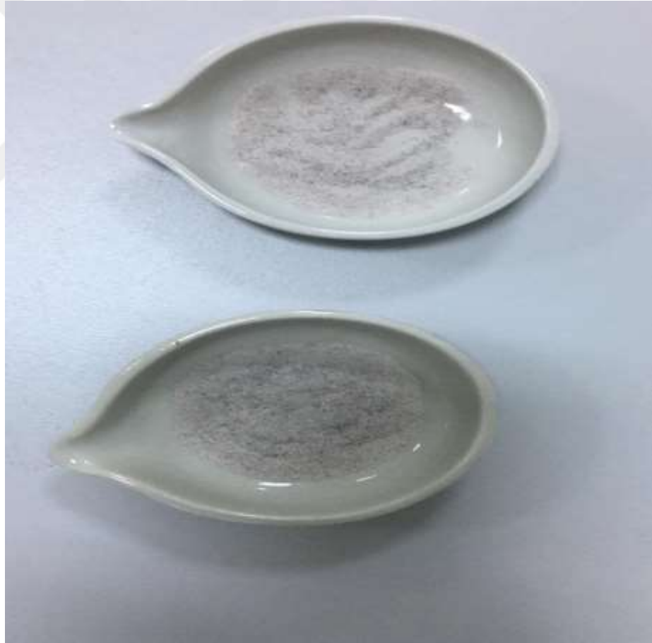
řekil 9: gtlerek yakma iřlemi uygulanmıř Osmancık pirin kabuėu [2 numaralı kroze stte, 3 numaralı kroze altta]
