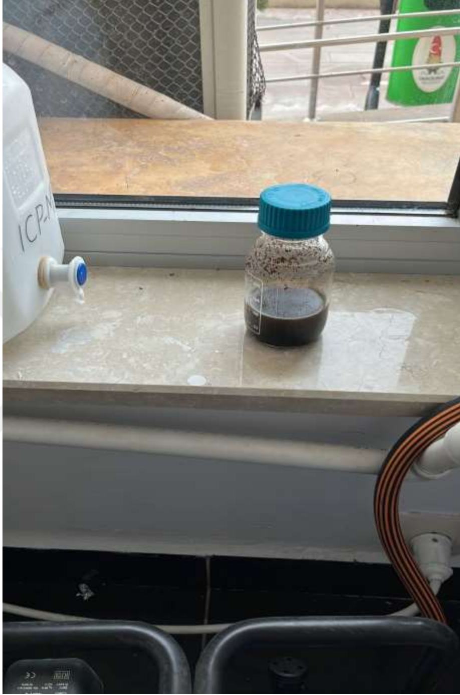
Şekil 11: %15 H_2SO_4 çözeltisi ile 1 saat süreyle 121^\circ C sıcaklıkta otoklavlanan ve başka işleme tabi tutulamayacak kadar yanan Osmancık pirinç kabuğu
