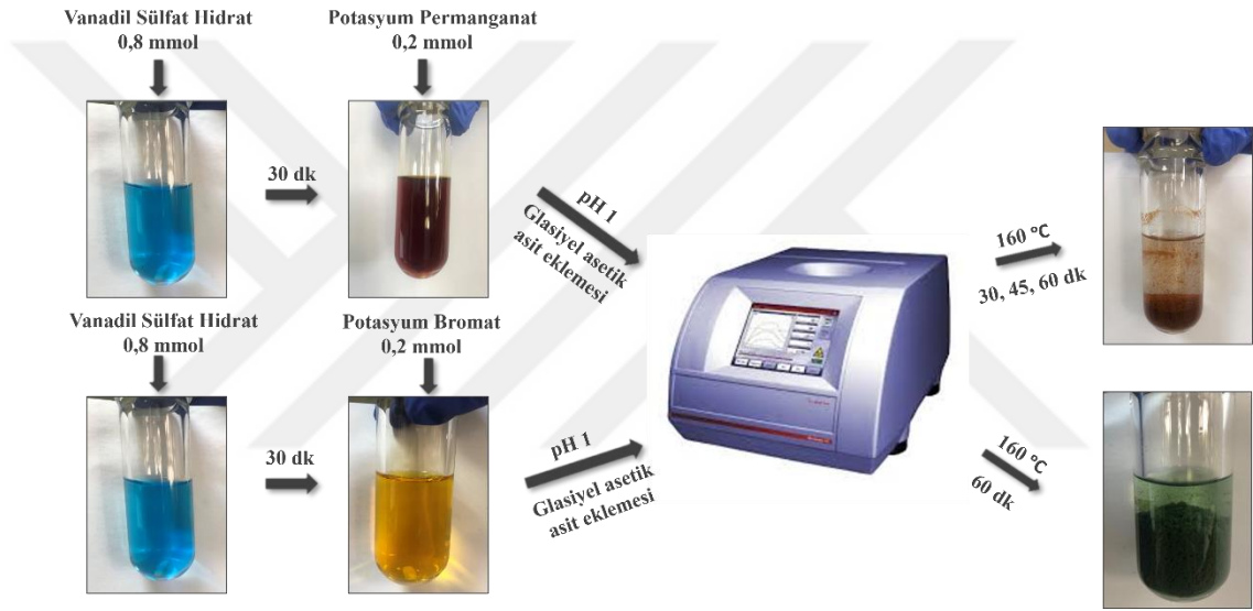
Şekil 3.2: Vanadyum-bazlı katot malzemelerin mikrodalga-destekli hidrotermal yöntemle sentezi.
