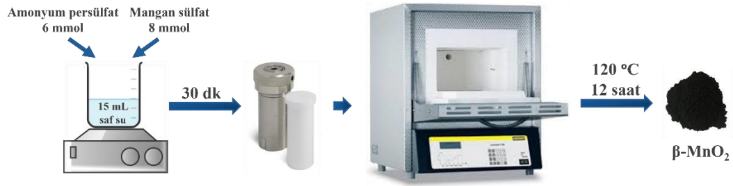
Şekil 3.1: \beta\text{-MnO}_2 'nin hidrotermal yöntemle sentez aşamaları.
