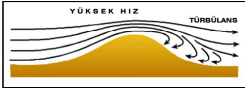
Şekil 29. Rüzgar Almayan Bölgelerdeki Türbülans Etkisi [30]
