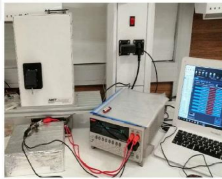
Şekil 3.15 Keithley 2400 ve Abet, LS10500 I-V ölçüm cihazı
