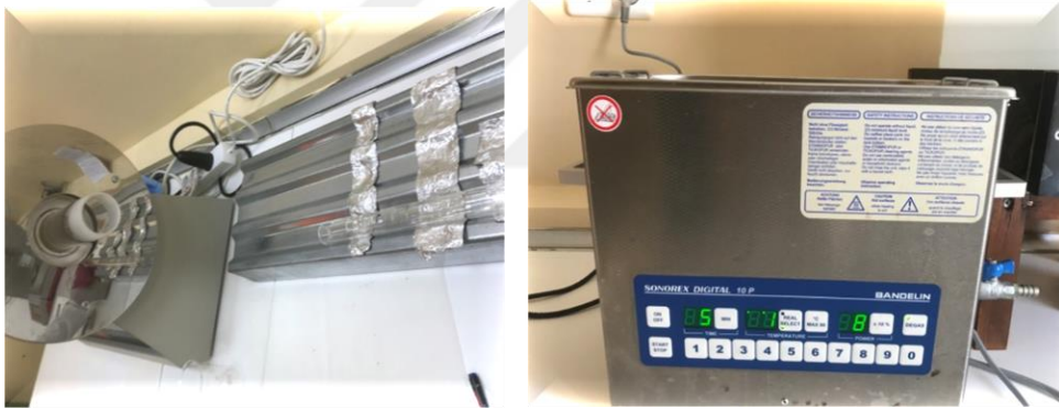
Şekil 3.2 FTO camların temizleme aşamaları
