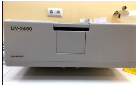
Şekil 3.12 Shimadzu UV-2450 UV-Vis spektrofotometre cihazı
