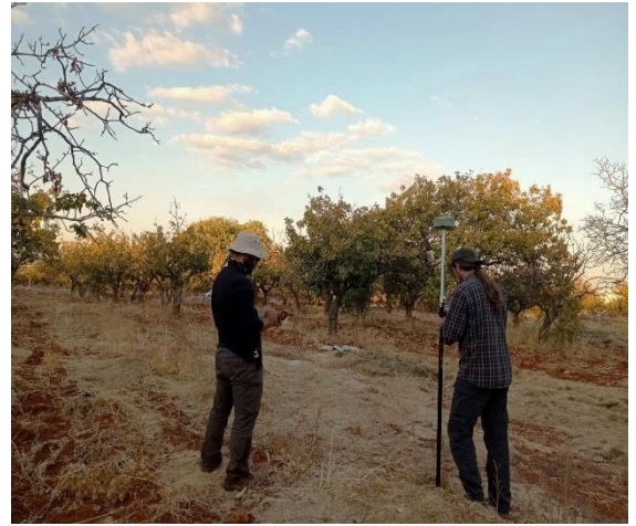
Resim 14. PaleoGaün 001 numaralı buluntu alanında GNSS Cors ile gözlem noktalarının oluşturulması
