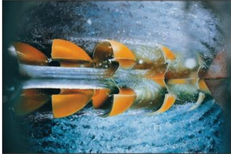
Şekil 3.8: Pelton çarkının su etkisi ile dönüşü(Çengel & Cimbala, n.d.).
