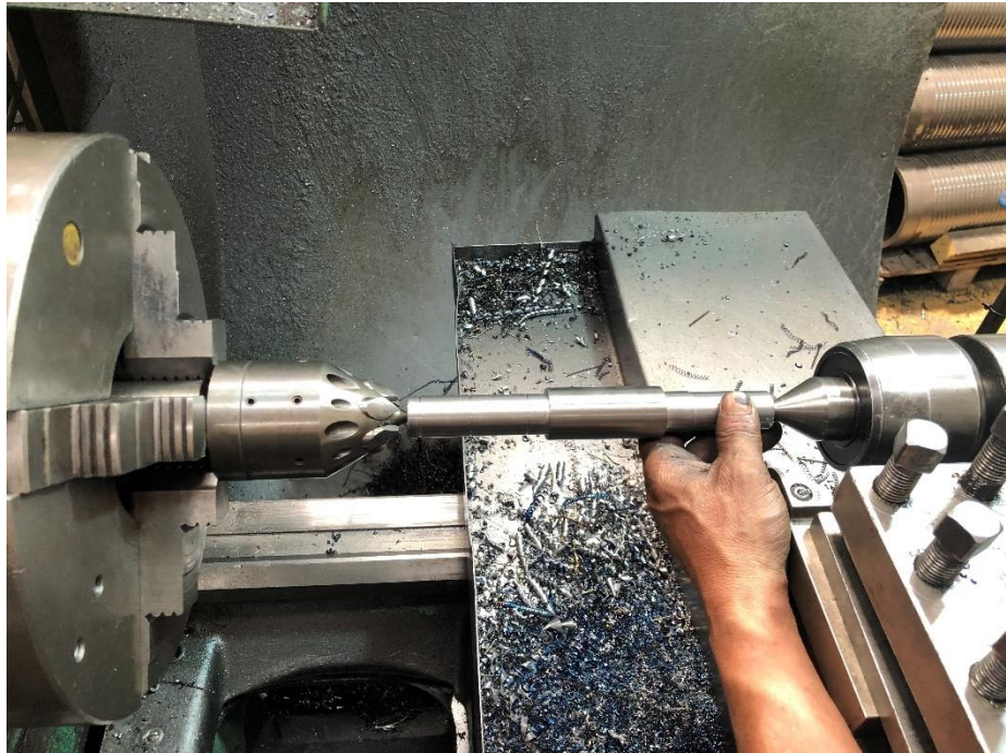
Şekil 4.8: Güç aktarım mili işlenme sonrası.
