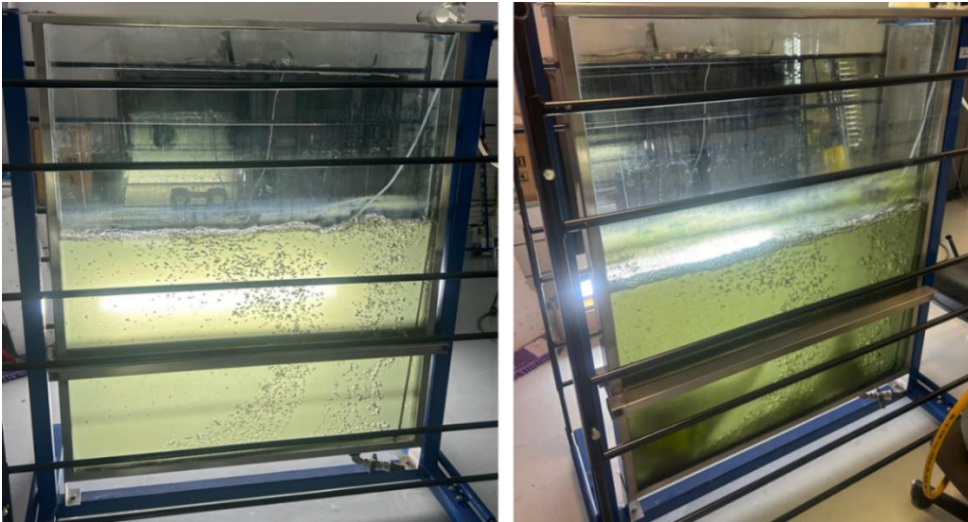
Şekil 3.19. N. linckia CALU-129 türünün 50 L panel fotobiyoreaktörlerdeki üretimi, solda, 3. gün; sağda, 12. gündeki durumu.
