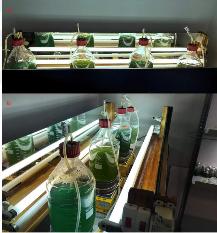
Şekil 3.5. Türlerin üretim sistemi a) Karşıdan görüntüsü; b) Yandan görüntüsü (2 L Schott şişelerde, havalandırma, hortum ve pompa ile; karıştırma, manyetik karıştırıcı ile gerçekleştirilmiştir).
