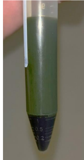
Şekil 3.20. Sıvı-sıvı partiyon. Altta pigmentleri sudan uzaklaştıran kloroform fazı, üstte shinorine içeren su fazı.
