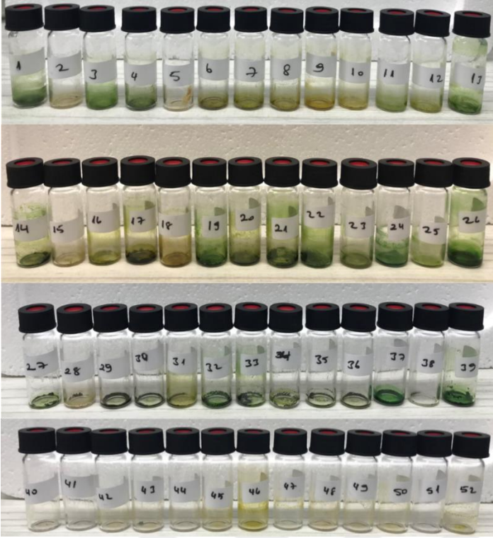
Şekil 4.5. Algatech kültür koleksiyonundan seçilen siyanobakteri türlerinin ekstraksiyonu sonrası elde edilen ekstraktların görüntüleri. 1-13 %70 metanol ekstraktları; 13-26 kloroform:metanol ekstraktları; 27-39 kloroform ekstraktları; 39-52 hekzan ekstraktları.
