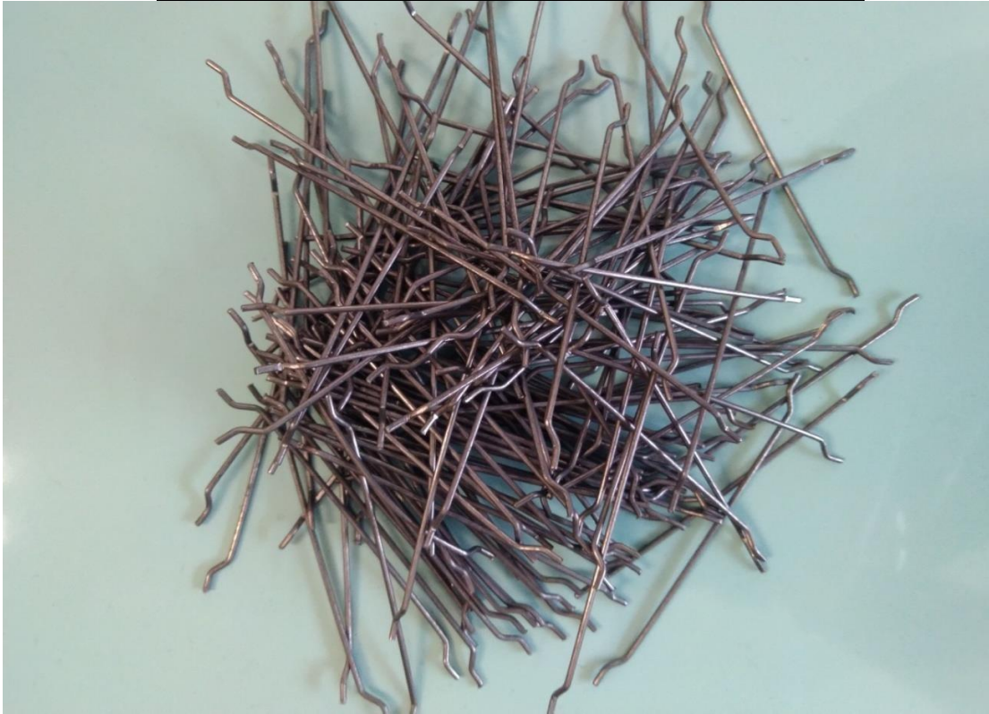
Şekil 3.1. Kanca uçlu çelik lif
