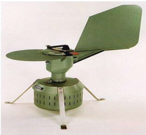
Şekil 4.1. Burkard polen tuzaklama aracının genel görünüşü
