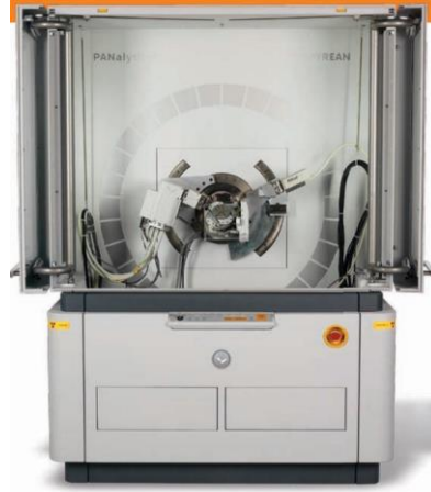
Şekil 3.4. X-ışını kırınımlı difraktometre (Malvern Panalytical EMPYREAN) cihazı
