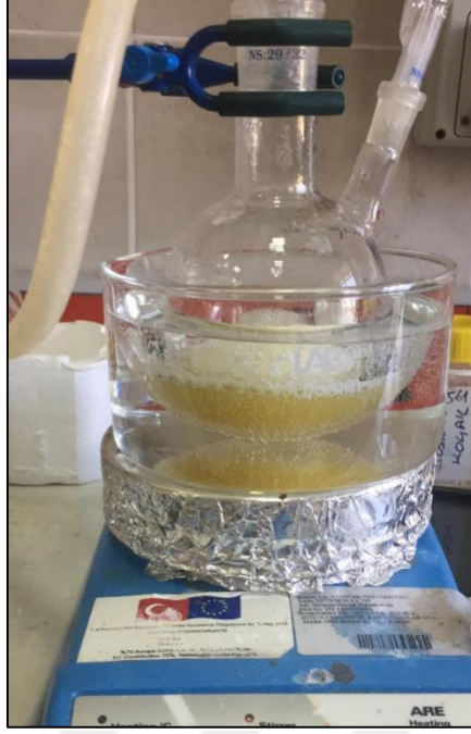
Şekil 3.2. Kompleks koaservasyon yöntemiyle enkapsülasyon
