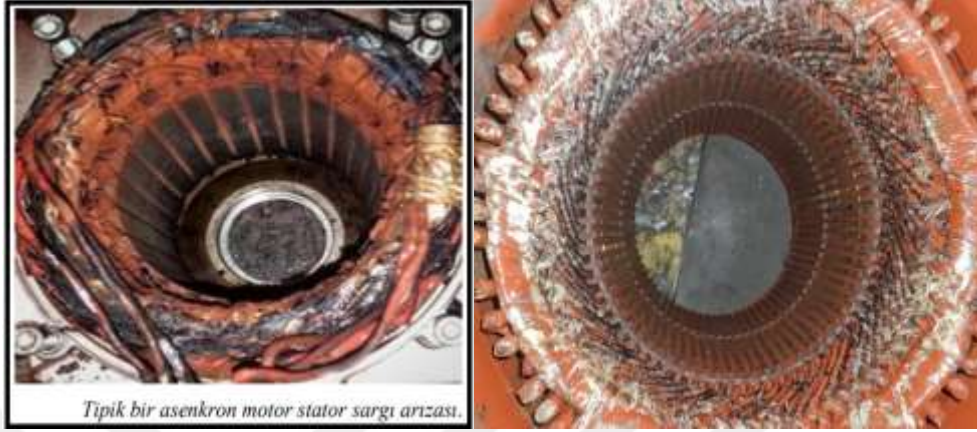
Şekil 3.6: Motorda Stator Yanıklarına İlişkin Görseller [27]
