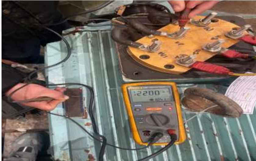
Şekil 3.13: Motorun Sargı ve Gövde Arası Meğer Testi-[Desan Tersanesi]
