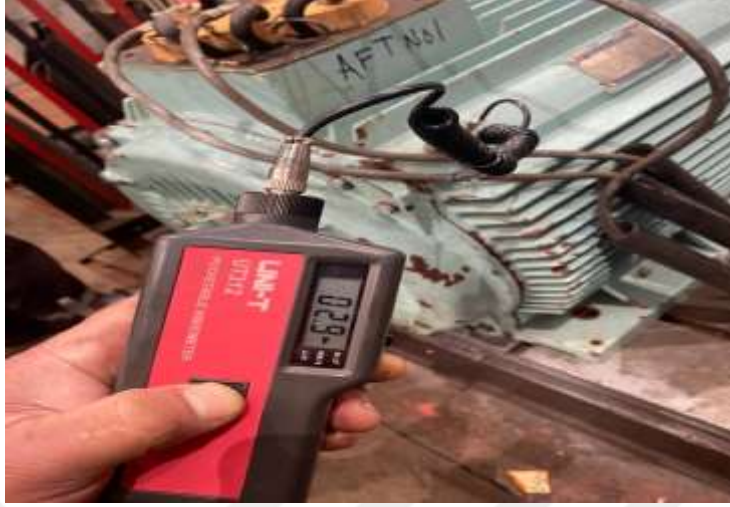
Şekil 3.16: UNI-T UT312 Titreşim Test Ölçüm Cihazı-[Desan Tersanesi]
