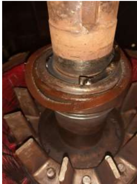
Şekil 3.3: Milde Kullanılan Ezilmiş Rulman Görüntüsü, (Motor Etiket: 55kW/440V/60Hz) [Desan Shipyard]
