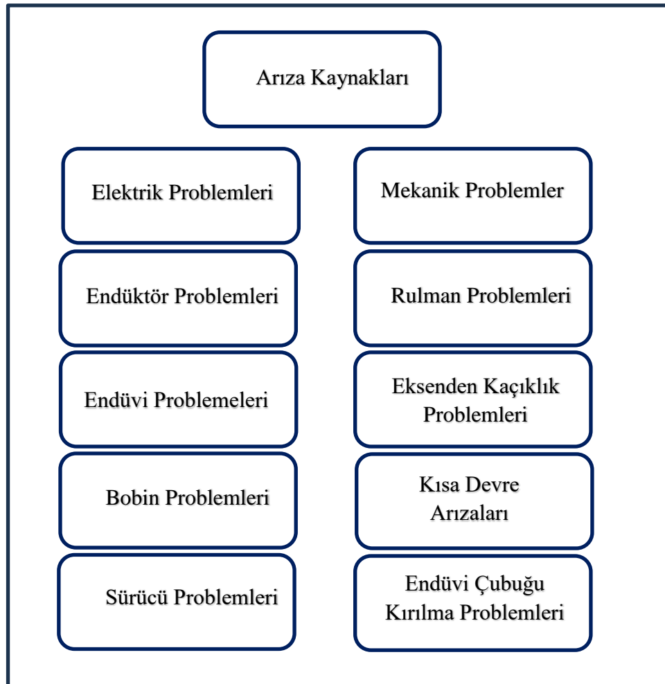
Şekil 1.2: Asenkron Motorlarda Oluşan Arıza Modelleri [9]
