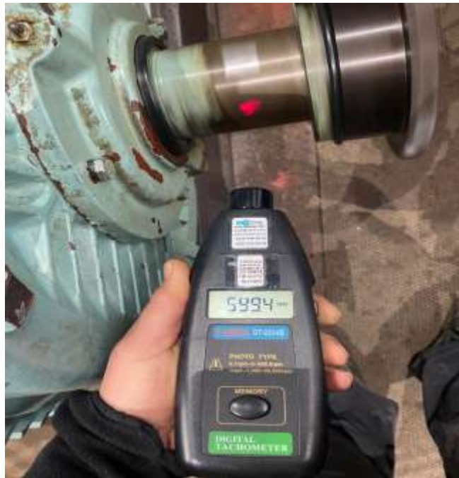
Şekil 3.17: Dijital Takometre Ölçüm Cihazı-[Desan Tersanesi]
