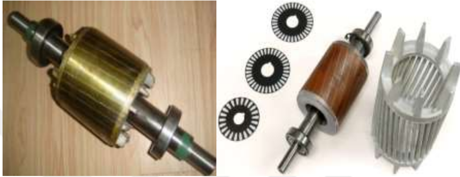
Şekil 2.20: Sincap Kafesli Rotorun Görüntüsü
