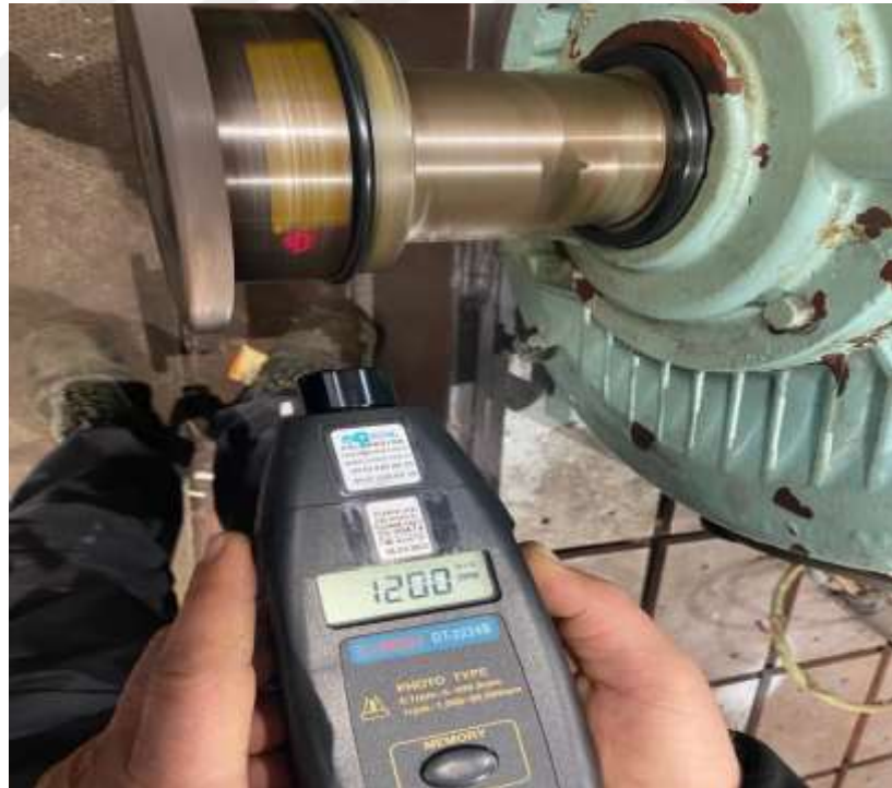
Şekil 3.19: Motora 60 Hz Frekans /1200 rpm/min – [Desan Tersanesi]
