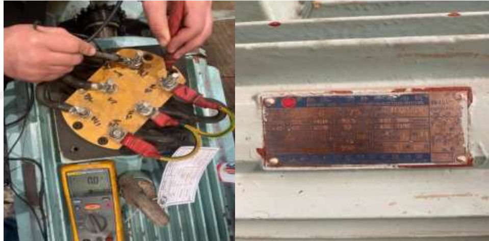
Şekil 3.11: Meğer Ölçümü Kontrolü – [Desan Tersanesi]
