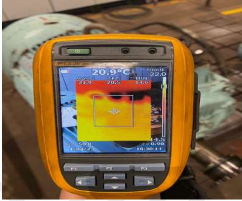
Şekil 3.20: Fluke Termal Kamera İle Gövde Isınma Testi – [Desan Tersanesi]
