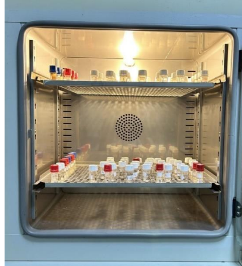
Şekil 3.5. Tüm örneklerin bekletildiği inkübatör (Nüve Soğutmalı İnkübatör ES 110, Ankara, Türkiye)
