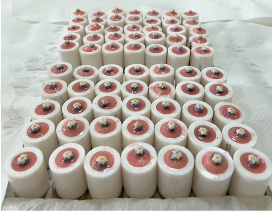
Şekil 3.10. Nişasta tüplerin çıkarılması için 1 gün boyunca nemli ortamda bekletilen örnekler
