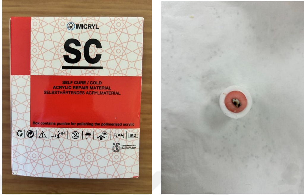
Şekil 3.7. Örneklerin akriliğe gömülmesi
