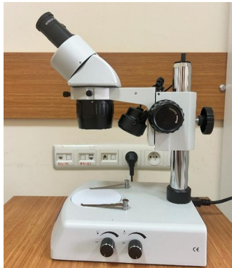
Şekil 3.14. Kırılma tiplerini incelemek için kullanılan steromikroskop
