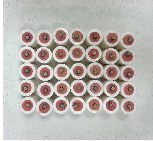
Şekil 3.9. Kompozit dolguların nişasta tüpler yardımıyla (Nuh'un Ankara Makarnası, Yıldız Şehriye) yapılması
