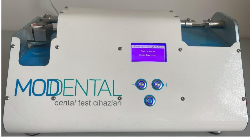
Şekil 3.13. Mikro makaslama bağlanma dayanımı testinin yapılması
