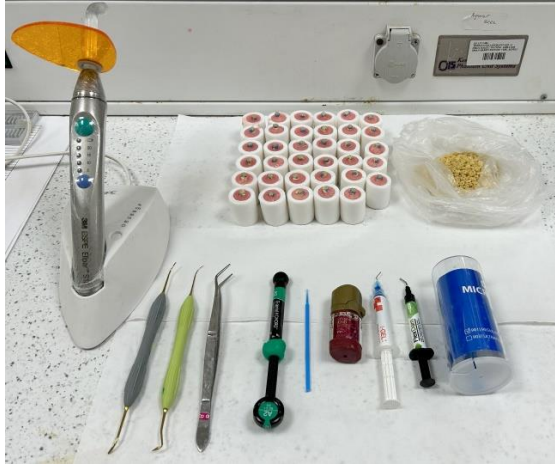
Şekil 3.9. Kompozit dolguların nişasta tüpler yardımıyla (Nuh'un Ankara Makarnası, Yıldız Şehriye) yapılması
