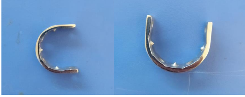
Şekil 13. Talaşlı imalat ile üretilen implant
