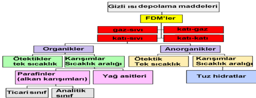
Şekil 2. GIED için kullanılan FDM'lerin sınıflandırılması (Zalba ve ark., 2003)
