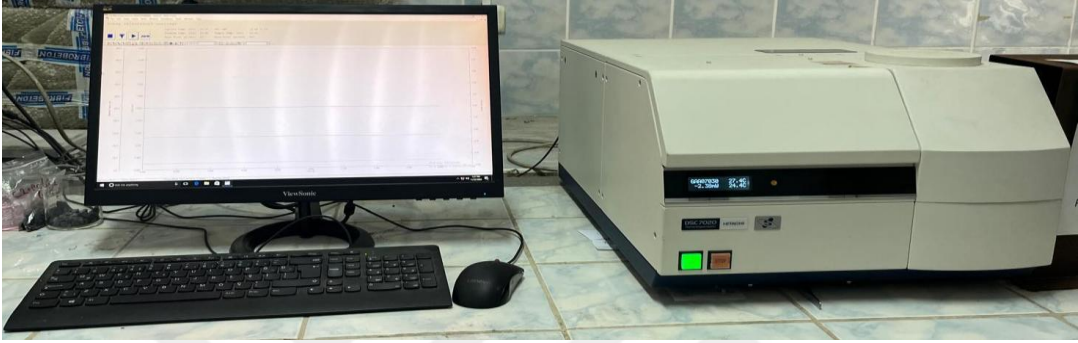
Şekil 16. DSC Cihazı (Hitachi-DSC 7020 Model)
