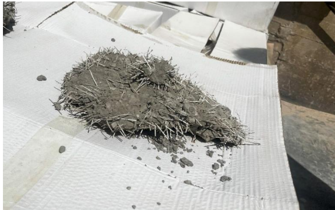
Şekil 3.16. Sertleşmiş beton atığı (Z. Turan arşivi).
