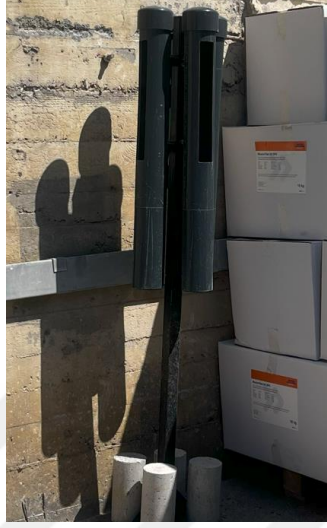
Şekil 3.12. Toz ölçüm cihazı (Z. Turan arşivi).
