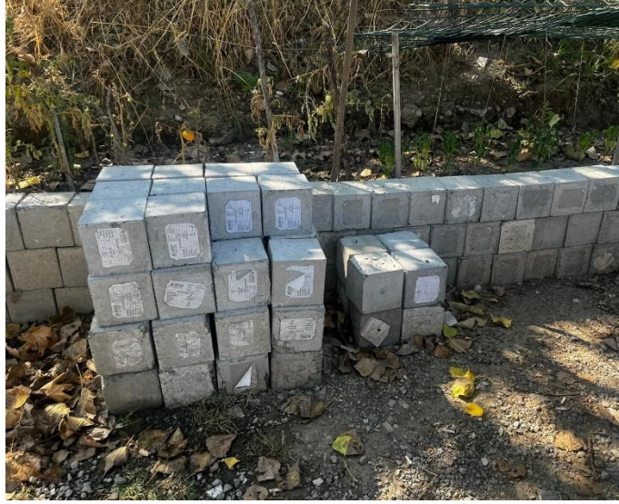
Şekil 3.14. Numune alma ve test işlemlerinden kaynaklı beton kalıntıları (Z. Turan arşivi).
