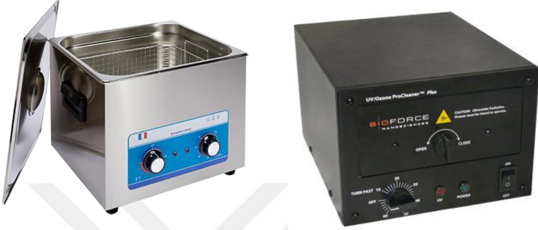
Şekil 3.2 : Altaşların temizliğinde kullanılan ultrasonik banyo (sol) ve UV-O3 cihazı (sağ).
