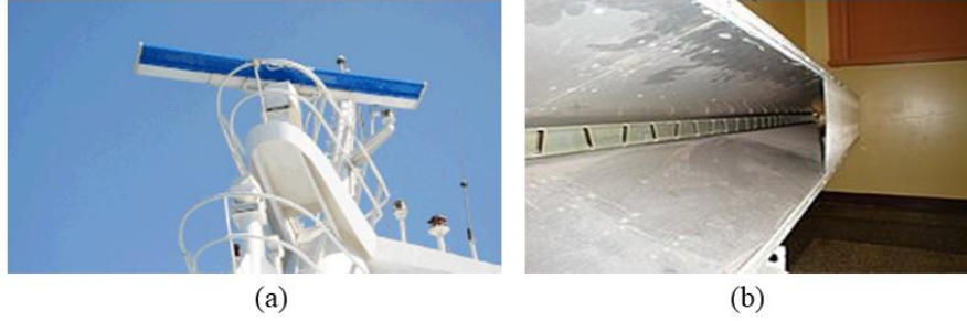
Şekil 1.2 (a) X-bant yarıklı dalga kılavuzu deniz radar anteni, gemide, 8–12 GHz. Anten, mikro dalgaların dar bir dikey fan şeklinde ışınımını yaparak, her dönüşte geminin etrafındaki tüm 360° su yüzeyini tarar (Anonymous 2011), ve (b) Benzer deniz radar antenin kesit görüntüsü, plastik radom kısmı çıkarılmış, dalga kılavuzundaki yarıklar gösterilmektedir (Anonymous 2009)
