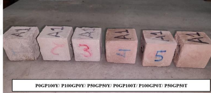
Şekil 3.21 Asit etkisindeki numune örnekleri
