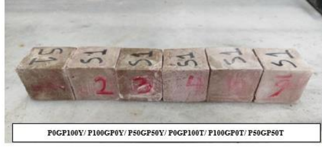
Şekil 3.20 Sülfat etkisindeki numune örnekleri
