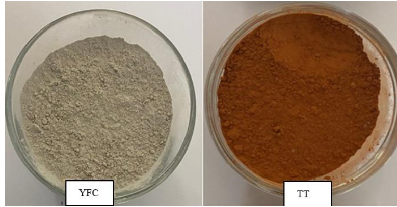
Şekil 3.5 Geopolimer harç yapımında kullanılan bağlayıcılar
