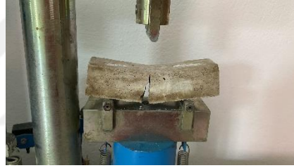
Şekil 3.16 Eğilme dayanımı deneyine tabi tutulan numunenin görünümü
