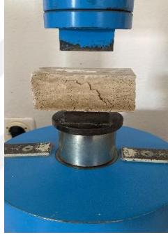
Şekil 3.15 Basınç dayanımı deneyine tabi tutulan numunenin görünümü
