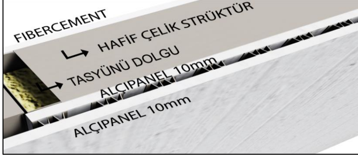
Şekil 4.4. Ön üretimli duvar panelleri katmanları
