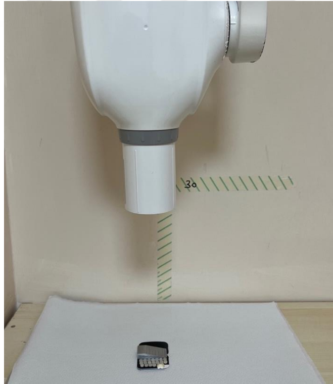
Şekil 3.10. Radyograflerin RVG ile alınması
