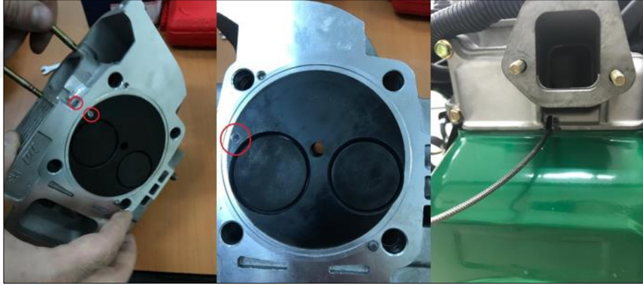
Şekil 6.11. Silindir kapağı delme ve basınç sensörü montaj işlemi.
