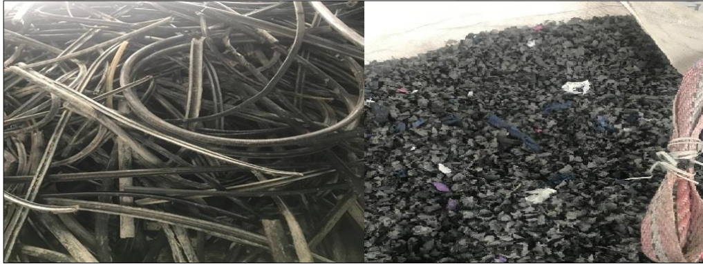
Şekil 6.20. Piroliz edilen XLPE malzeme.
