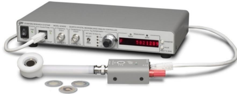
Şekil 3.4. Nem algılama çalışmalarında kullanılan QCM cihazı
