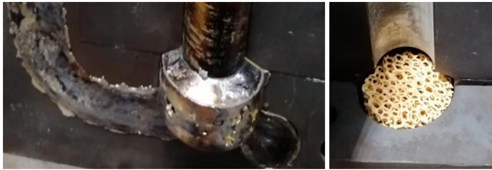
Şekil 3.3. Yolluğa yerleştirilen seramik döküm filtresi görüntüsü
