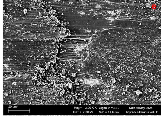
Şekil 4.36. Bir kere dövme işlemi uygulanmış EZ43A alaşımının Adhezih aşınma testi sonrası SEM görüntüsü (a) Makro görüntü (b) 200x (c) 500x (d) 1kx (e) 2kx
