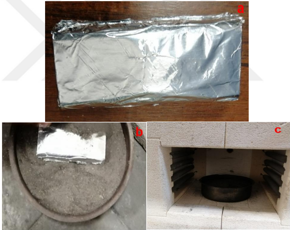
Şekil 3.6. a) Alaşımın folyolanmış görüntüsü b) Alaşımın folyo içinde kuma gömülme işlemi c) Alaşımın homojenleştirme fırınına konulmuş hali.
