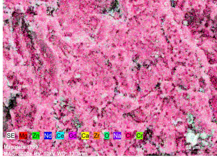
Şekil 4.57. Ekstrüzyon sonrası EZ43B alaşımlarının daldırma korozyon testi MAP görüntüsü
