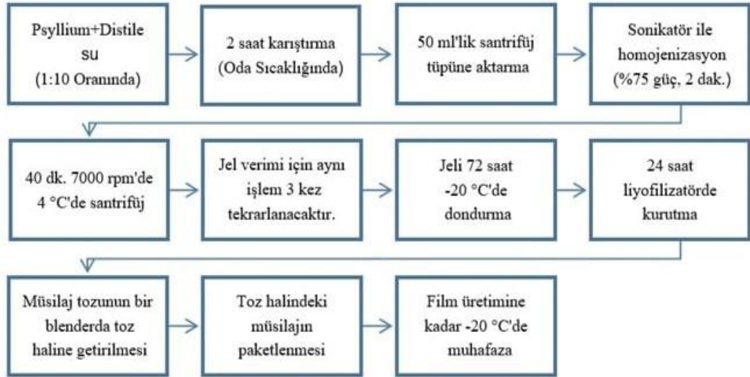
Şekil 3.3. Psyllium tohumlarından müsilaj ekstraksiyonu akım şeması
