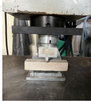
Şekil 3.9 Eğilme Direnci Testi
