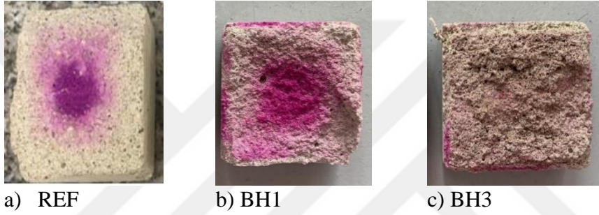
Şekil 6.7 7. gün karbonatlaşma derinliği
