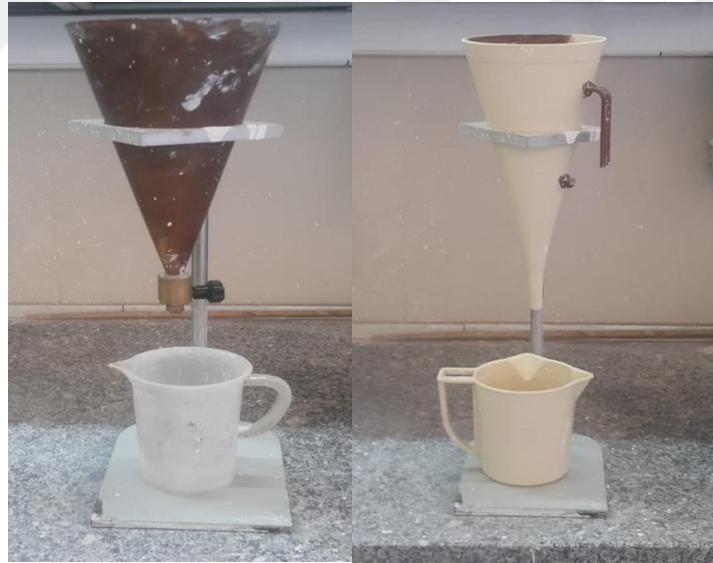
Şekil 4.2 Akış konisi ve Marsh hunisi
