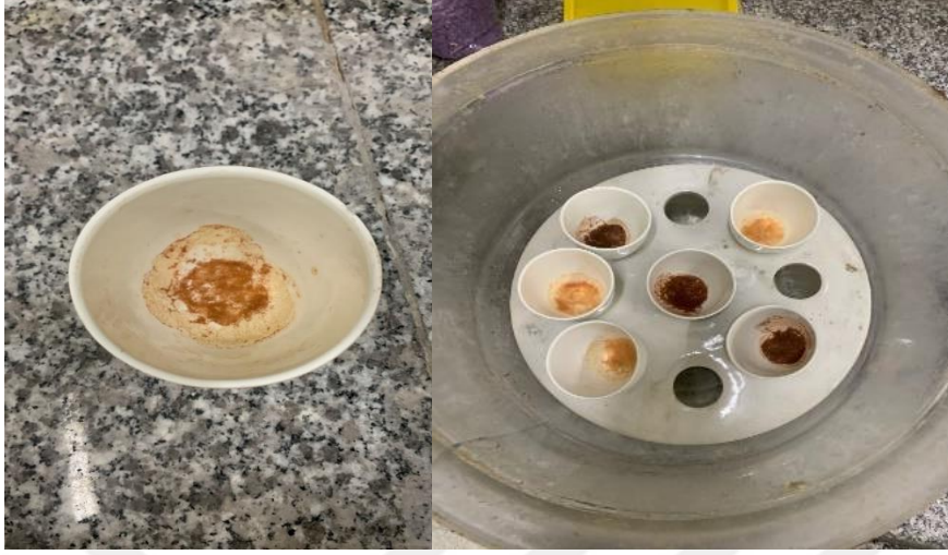
Şekil 5.6 Kül sonucu numune ve desikatörde soğutma işlemi
