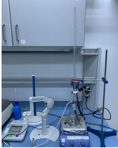
Şekil 5.4 Titrasyon deney düzeneği
