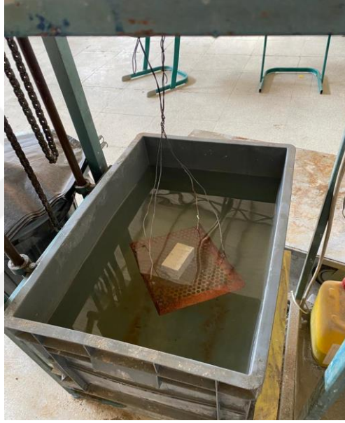
Şekil 3.7 Suya doygun haldeki numunelerin suda tartılmaları
