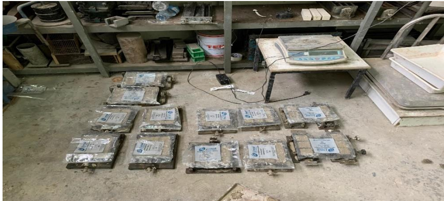
Şekil 3.5 Taze haldeki harçların kalıplara dökülmesi
