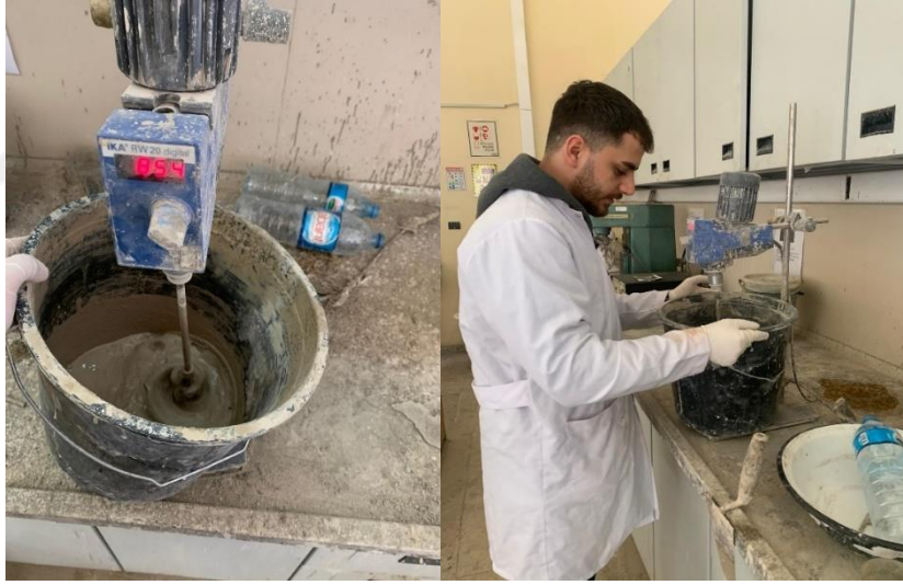
Şekil 4.1 Enjeksiyon malzemesi üretimi
