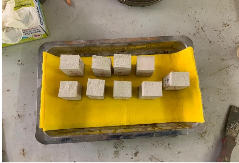
Şekil 3.8 Islak bezde beklemekte olan numuneler
