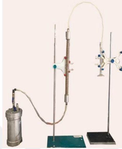
Şekil 4.4 Kum kolonu deney düzeneği
