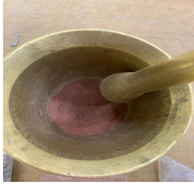
Şekil 3.3 Elekten geçirilen kurutulmuş atık kan malzemesi
