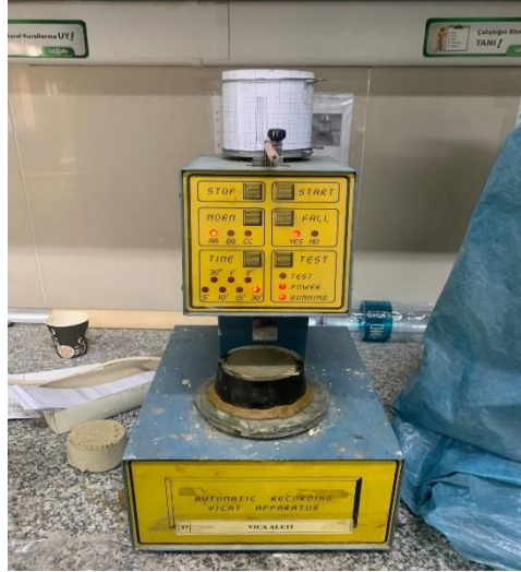
Şekil 3.6 Vicat aleti ile priz süresinin belirlenmesi işlemi
