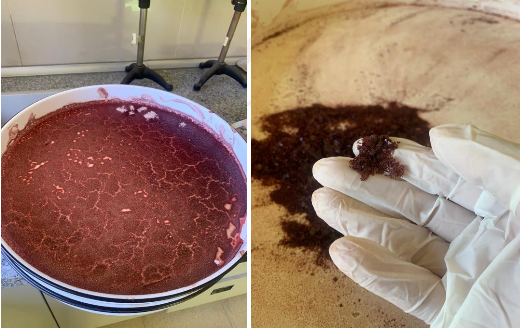
Şekil 3.2 UV ışık altında kurutulmuş atık kan
