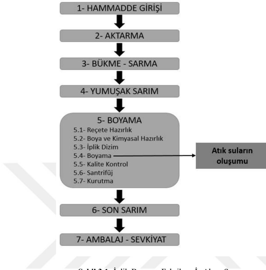
Şekil 3.1: İplik Boyama Fabrikası İş Akım Şeması
