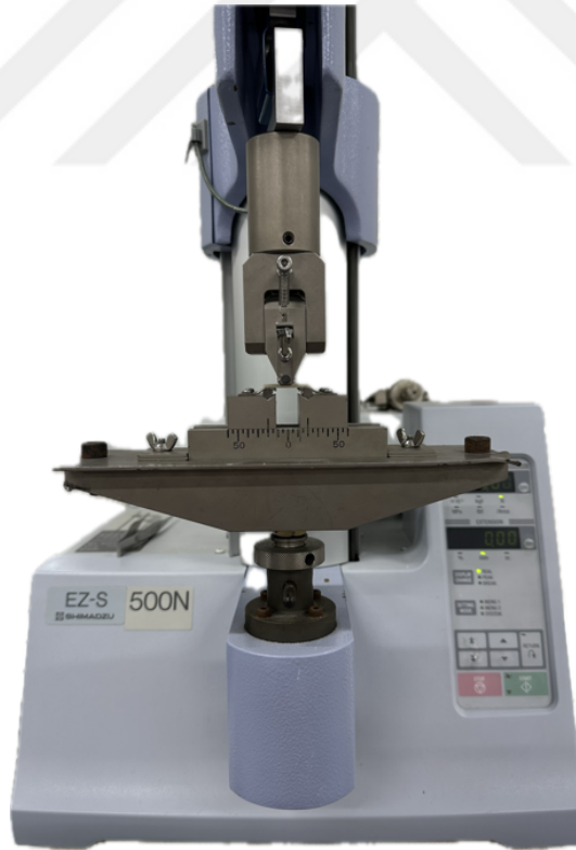
řekil 5.2.2. Bařlıkları 3 nokta testi iin ayarlanmıř universal test cihazı
