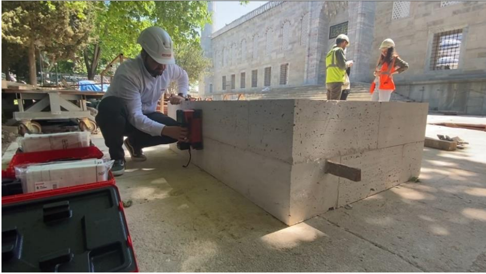
Şekil 4.22 Deney düzeneği radar ölçümü
