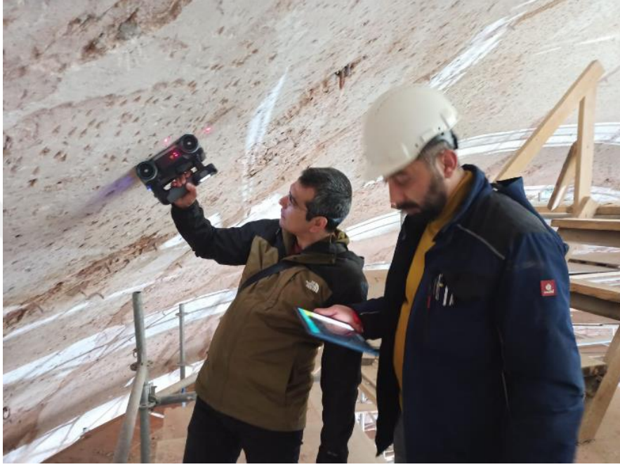
Şekil 4.36 Süleymaniye Camii ana kubbesi radar ölçümü
