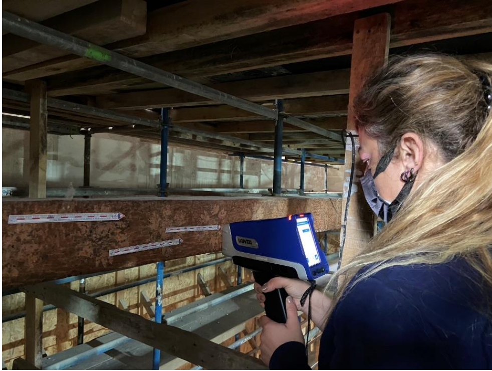
Şekil 4.76 Sultan Ahmet Camii gergilerinin XRF ile kimyasal içeriklerinin tespiti
