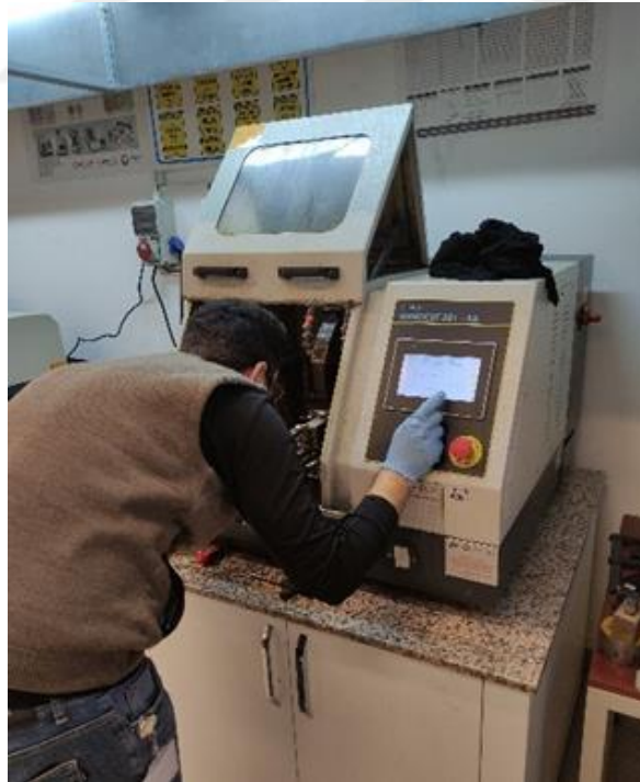
Şekil 3.2 Demir numunenin kesilmesi
