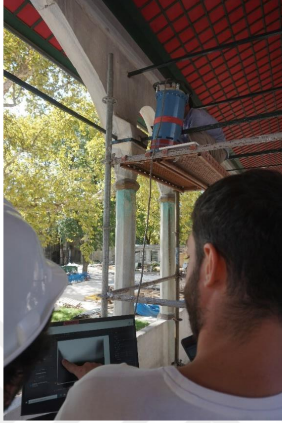
Şekil 4.47 Sultan Ahmet Camii sütun başlarında radyografi yöntemi ile tespit çalışması
