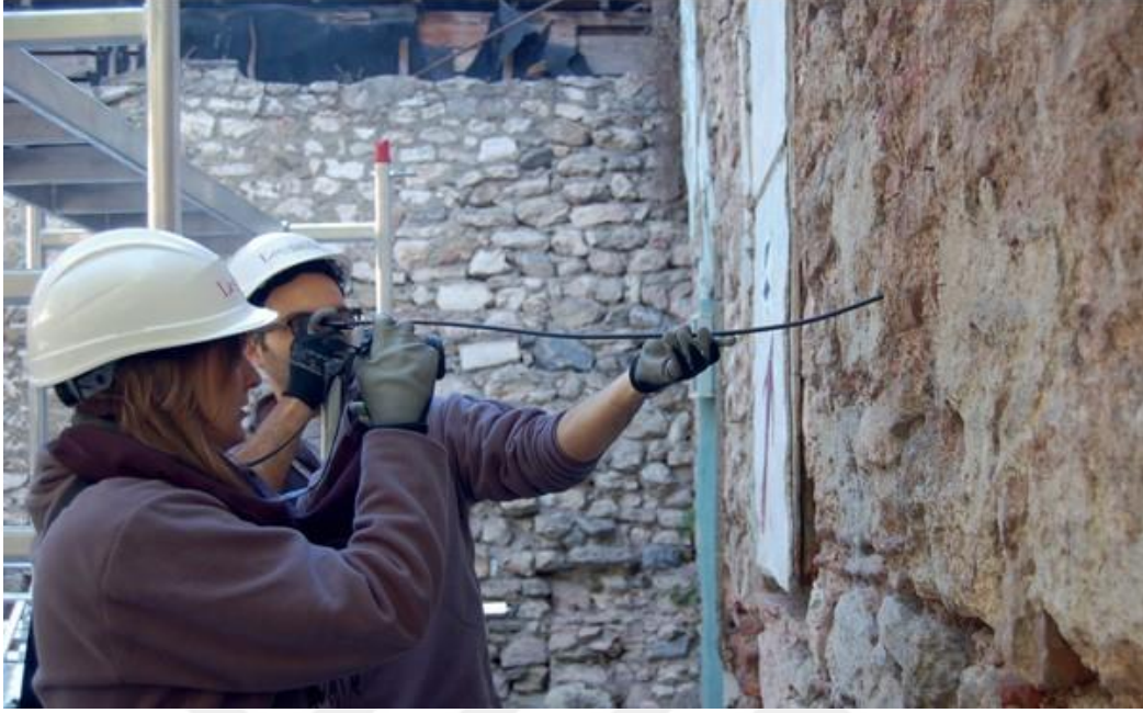
Şekil 3.14 Tarihi yapıda endoskopi uygulaması (Ahunbay vd., 2017)
