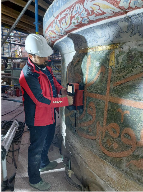
Şekil 4.26 Sultan Ahmet Camii fil ayağı radar taraması
