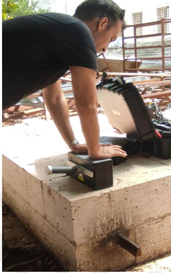
Şekil 4.55 Deney düzeneği ultrasonik tomografi ölçümü
