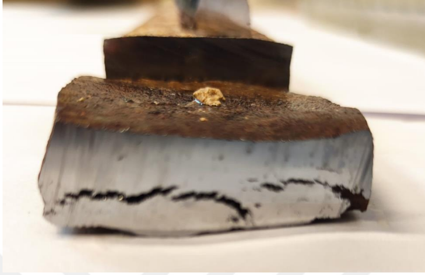
Şekil 4.84 Yeterince ısıtılmadan şekillendirildiği düşünülen Sultan Ahmet Cami'ne ait demir kenet
