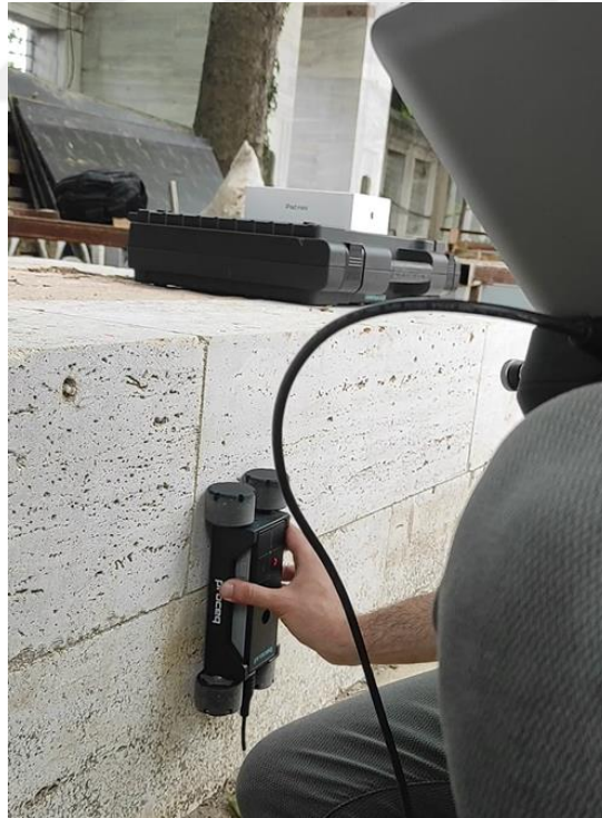
Şekil 4.42 Deney düzeneğinde yer alan demir elemanların manyetik indüksiyon yöntemi ile tespiti
