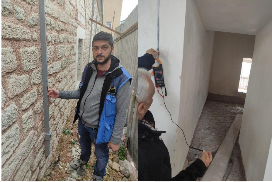
Şekil 4.63 Karadeniz Medresesi demir kılıçlama elemanlarının darbe yansıma yöntemi ile tespiti
