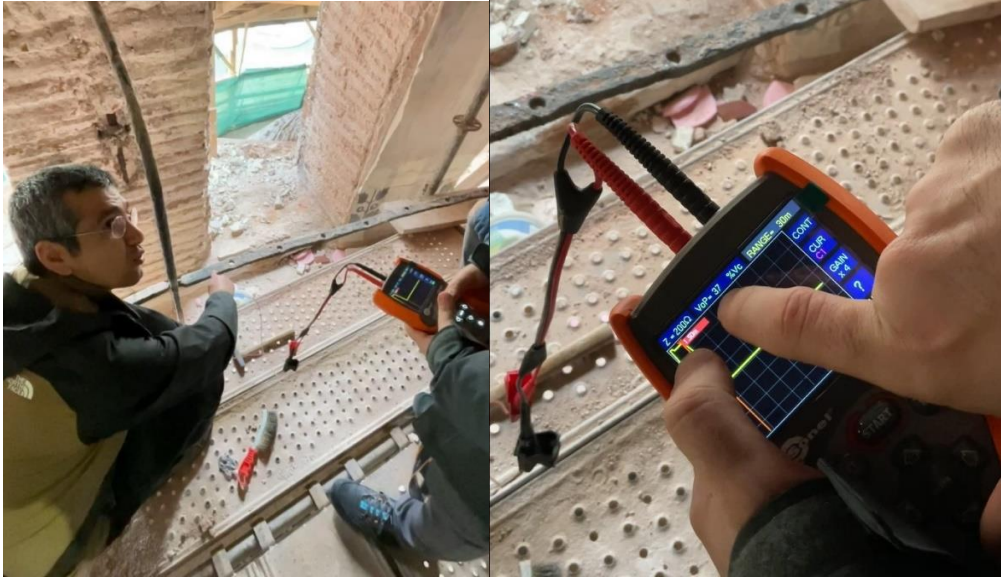
Şekil 4.69 Gazi Atik Ali Paşa Cami’nde darbe yansıma yöntemi ile yapılan araştırmalar
