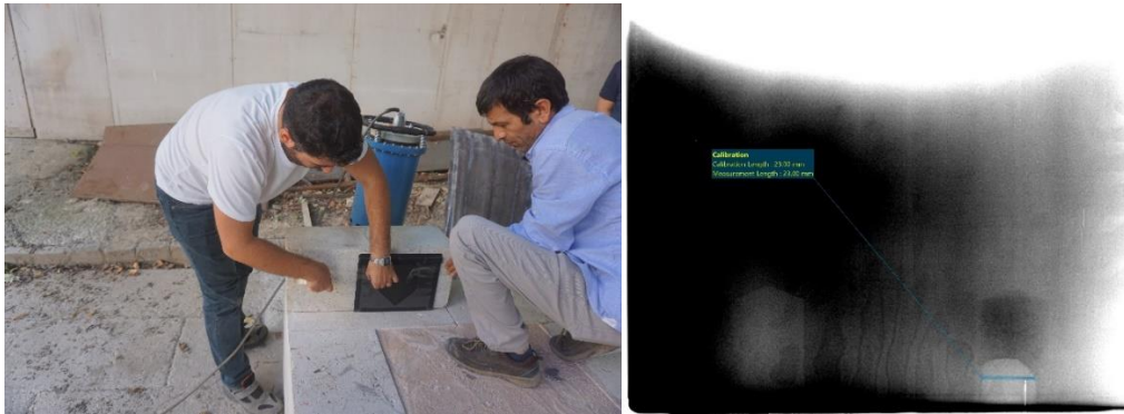
Şekil 4.49 Kesme taşın içinde yer alan demir elamana ait radyografi görüntüsü
