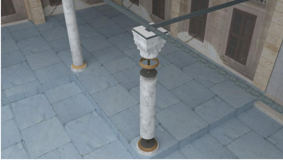
Şekil 2.6 Gergi sütun başı mesnet detayı
