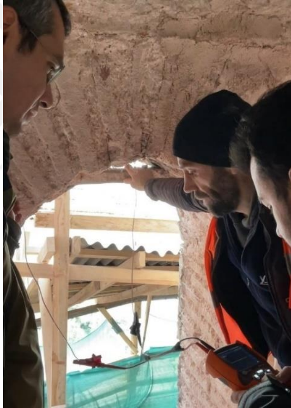
Şekil 4.70 Gazi Atik Ali Paşa Cami'nde darbe yansıma yöntemi ile yapılan araştırmalar
