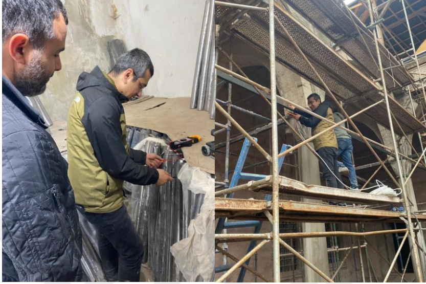
Şekil 4.66 a) Kurşunun elektrik iletkenliğinin testi b) Revak gergilerinin darbe yansıma yöntemi ile devamlılığının araştırılması
