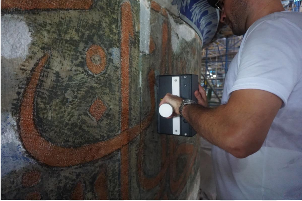
Şekil 4.56 Sultan Ahmet Camii fil ayağı ultrasonik tomografi ölçümü
