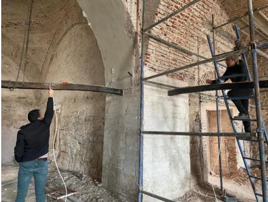
Şekil 4.67 Darbe yansıma yöntemi ile Süleymaniye İmaret yapısının gergilerinin devamlılığının araştırılması
