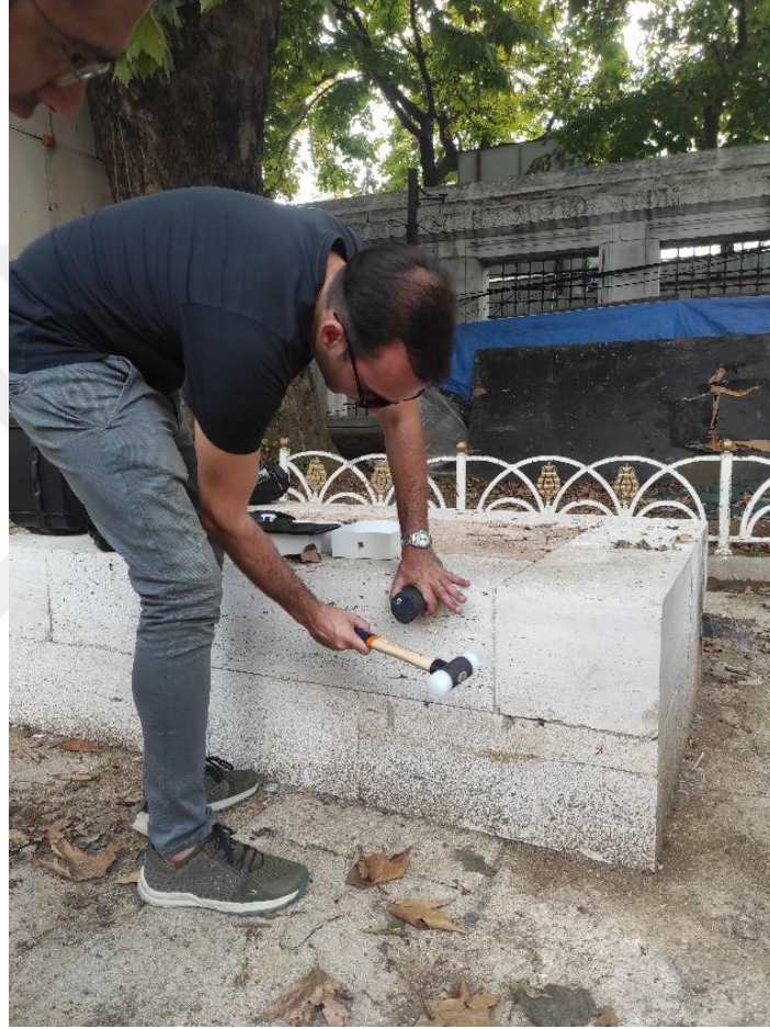
Şekil 4.51 Deney düzeneği içerisinde yer alan demir elemanların ultrasonik dalga hızı yöntemiyle tespit çalışması
