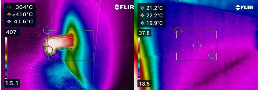
Şekil 4.59 a) Gergi demirinin yaydığı ısı b) Deney düzeneği taş yüzeyinin yaydığı
