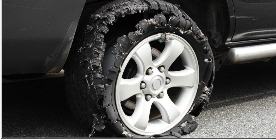
Resim 2.3. Yanaktan deforme olmuş ve ply malzemesi ortaya çıkmış lastik [13]
