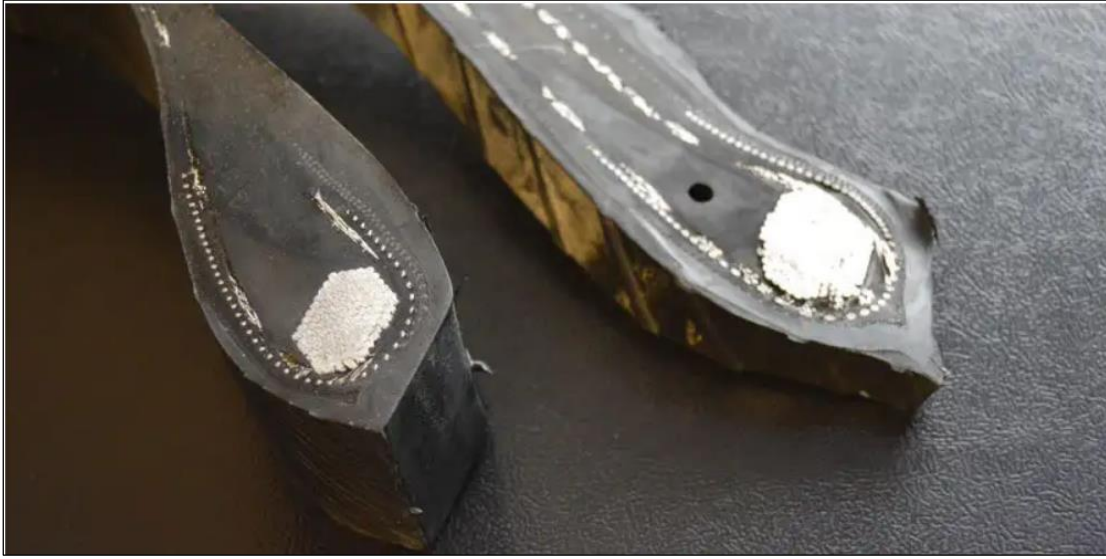
Resim 2.1. Topuk iç yapısı [10]
