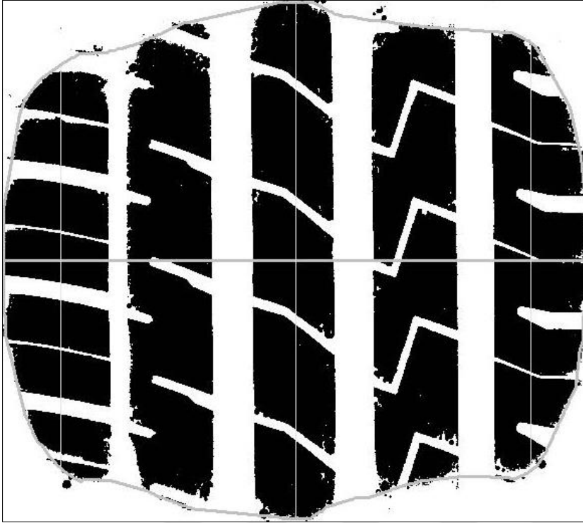
Şekil 5.17. 26° çelik kord ve 3mm boşluklu polyamid kord sarımı temas izi
