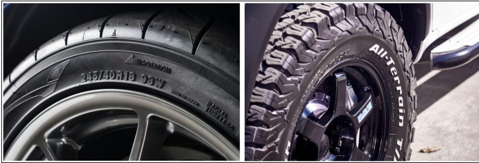
Resim 2.7. İki farklı yanak kalınlığına sahip binek taşıt lastiği [20]
