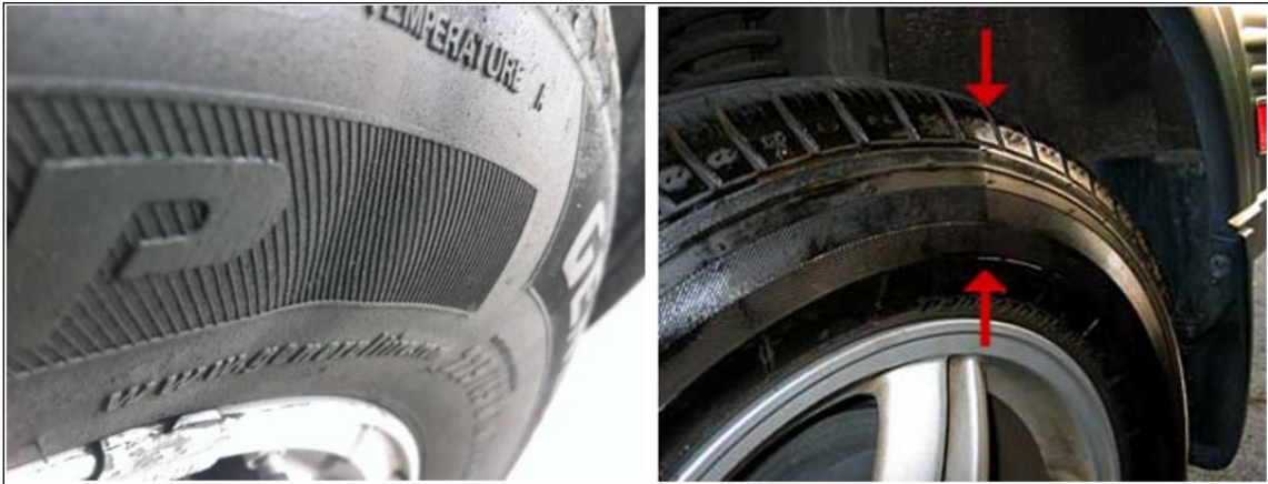
Resim 2.4. Ply malzemesi kaynaklı yanakta göçüklük ve şişkinlik hataları [14]
