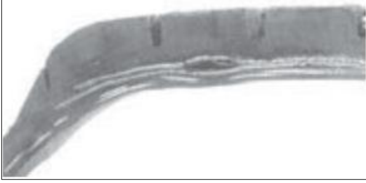
Resim 2.6. Üretim kaynaklı çelik kord hatası [18]
