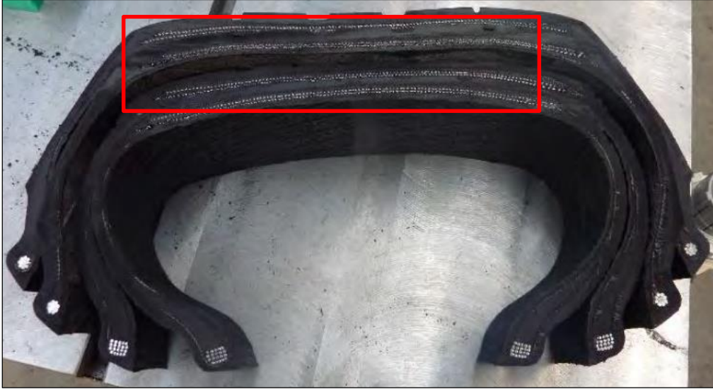
Resim 2.5. Çelik kord malzemesi gözükken lastik kesiti [17]
