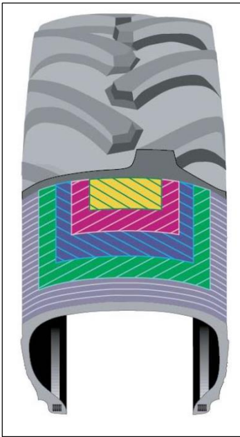
Şekil 2.6. Radyal lastik yapısı [9]
