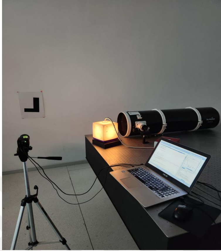
Şekil 3.28 Duvar aydınlatması ve MTF ölçümü
