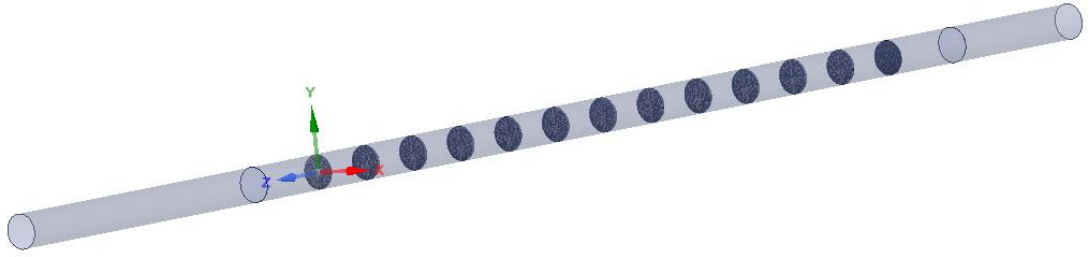
Şekil 2.15. Daire Yapıya Sahip, 5\text{mm}^2 ve p/d=1 olan türbülötör yerleşimi (Model 7)
