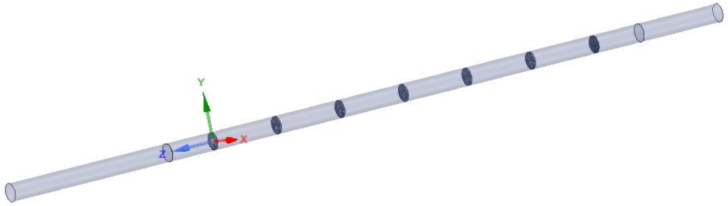
Şekil 2.16. Daire Yapıya Sahip, 5\text{mm}^2 ve p/d=2 olan türbülötör yerleşimi (Model 8)
