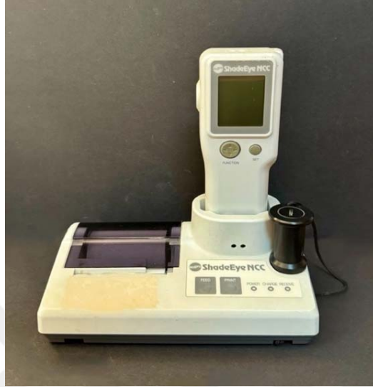
Resim 8. Shofu firmasının ShadeEye NCC Kolorimetre cihazı
