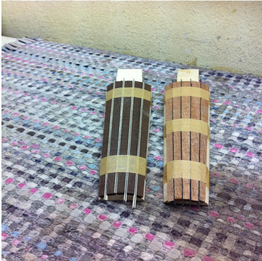
fotoğraf 24 ud sap kaplaması (Recep ÖZDEMİR 2024)
