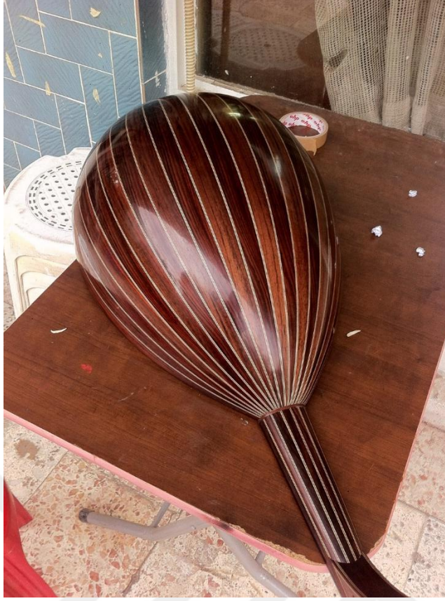
fotoğraf 11 selülozik vernik sonrası parlatma (Recep ÖZDEMİR 2024)
