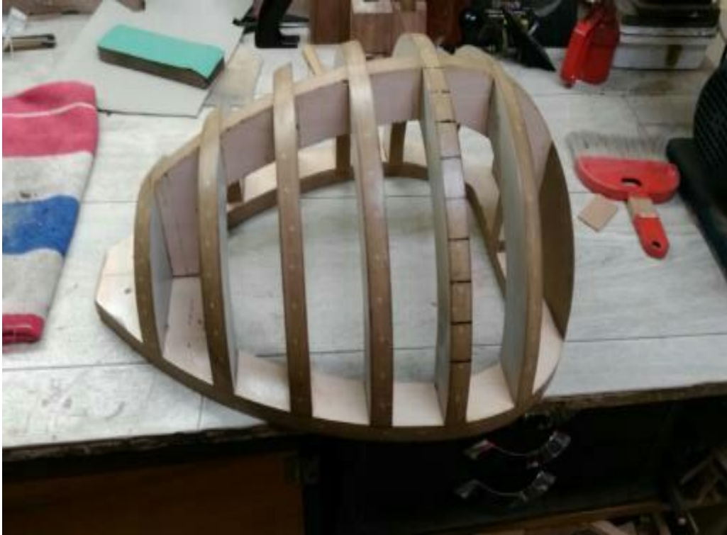
fotoğraf 15 ud tekne kalıbı (Recep ÖZDEMİR 2024)
