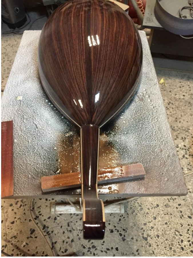
fotoğraf 9selülozik dolgu verniği uygulaması (Reep ÖZDEMİR 2024)
