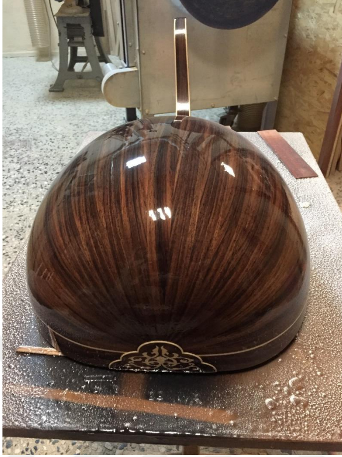
fotoğraf 10 selüozik parlak vernik uygulaması (Recep ÖZDEMİR 2024)
