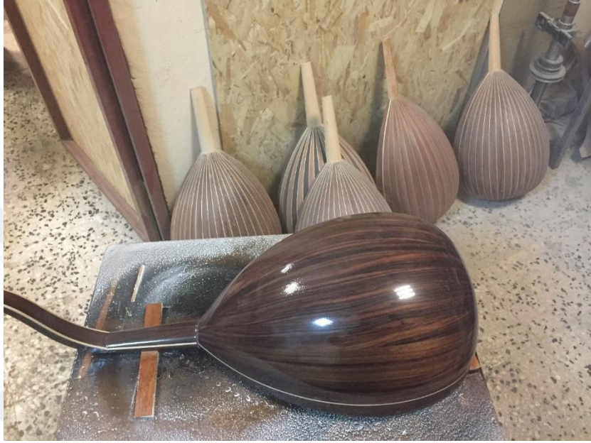
fotoğraf 8 selülozik dolgu verniği uygulaması (Recep ÖZDEMİR 2024)
