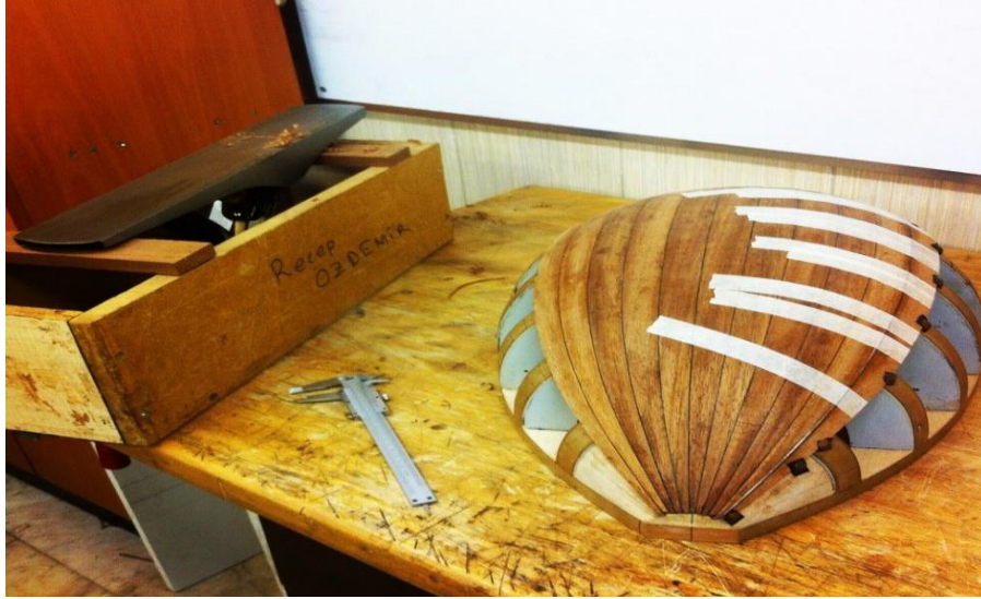
fotoğraf 19 dilim aşırması (Recep ÖZDEMİR 2024)
