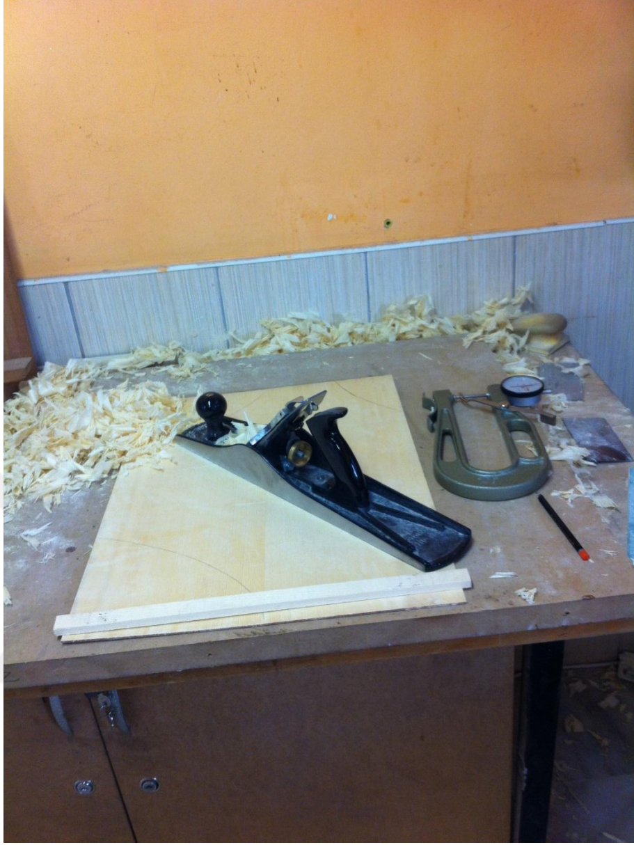
fotoğraf 29 ud ses tahtası ölçülendirmesi (Recep ÖZDEMİR 2024)
