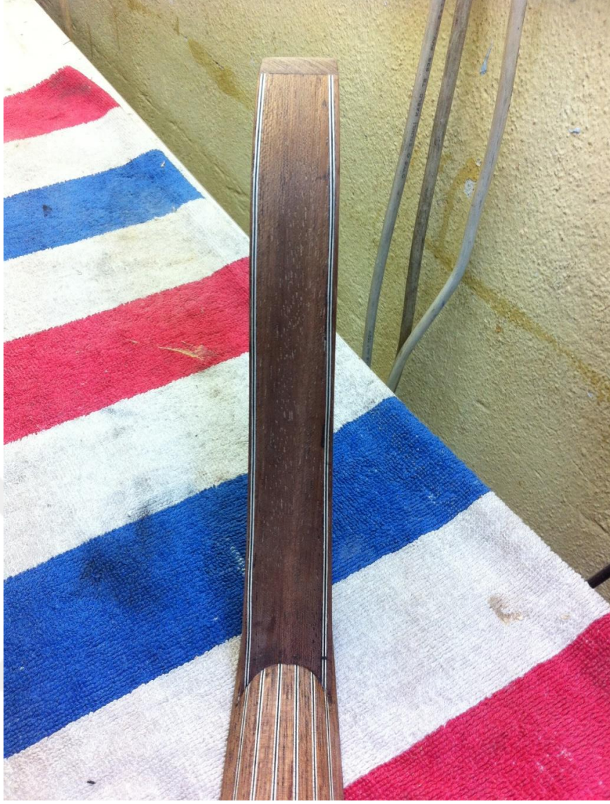
fotoğraf 28 ud burguluđu sapa takılmış hali (Recep ÖZDEMİR 2024)
