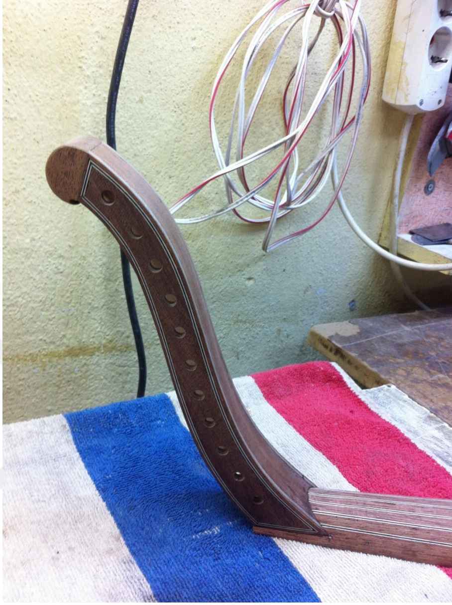
fotoğraf 27 ud burguluđu sapa takılmıř hali (Recep ÖZDEMİR 2024)
