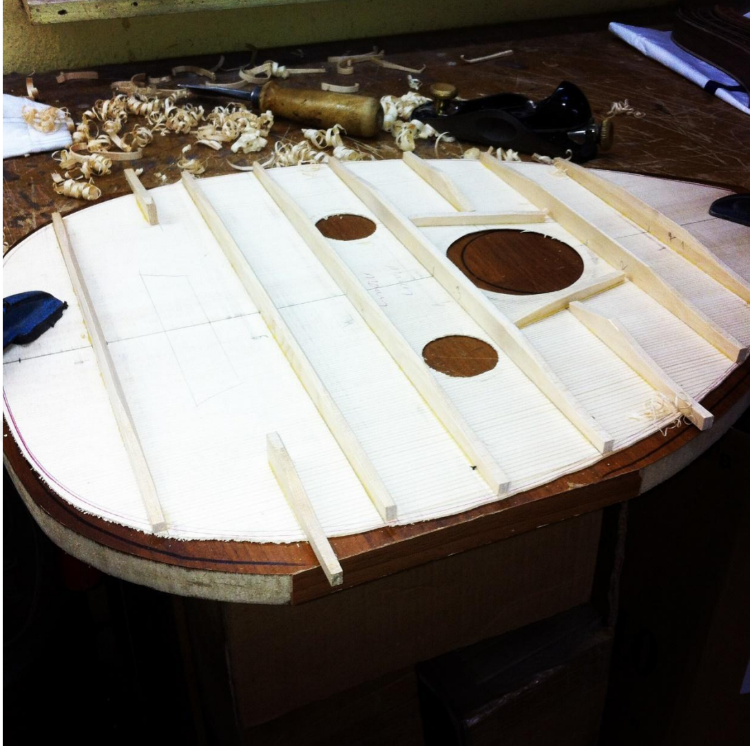
fotoğraf 31 ud ses tahtası balkon öçülendirmesi (Recep ÖZDEMİR 2024) ı
