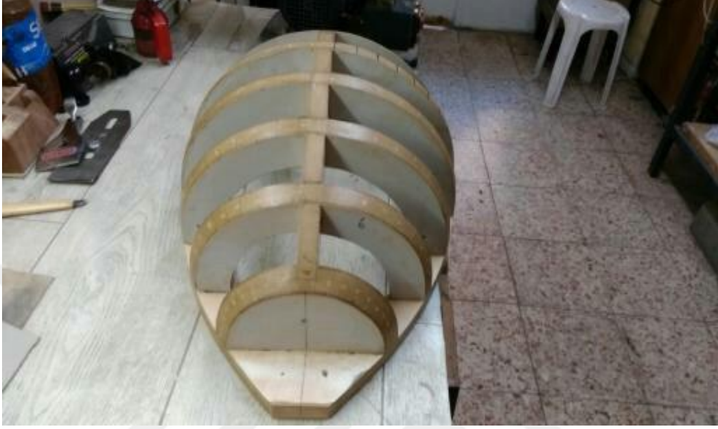
fotoğraf 14 ud tekne kalıbı (Recep ÖZDEMİR 2024)
