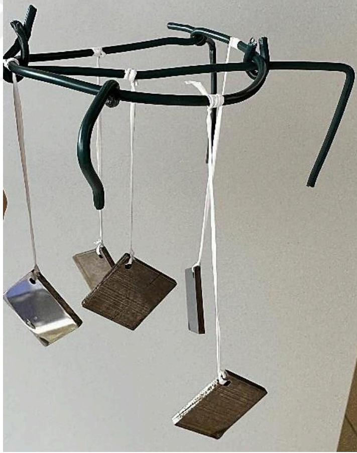
Şekil 6.4. Askı aparatına yerleştirilmiş numuneler
