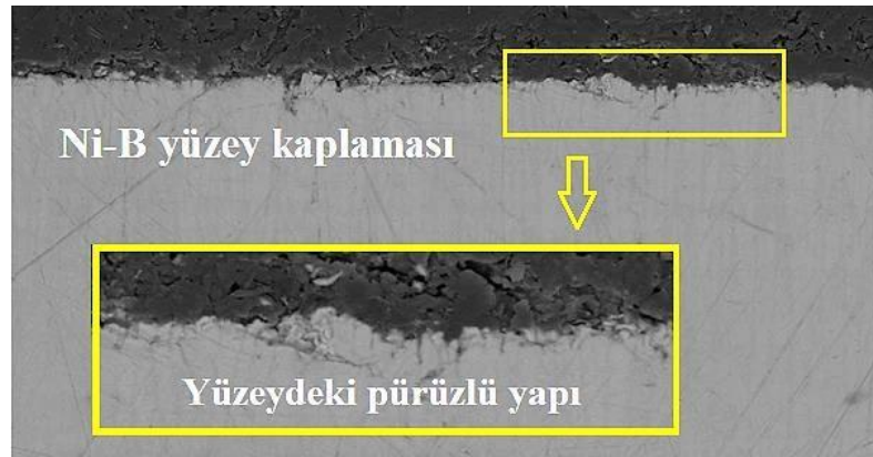
Şekil 7.11. Ni-B kaplama kesit BSE görüntüsü
