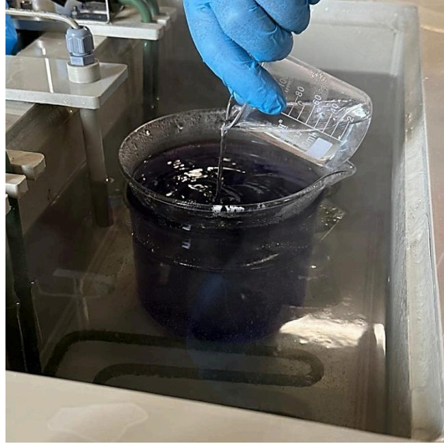
Şekil 6.11. NaBH_4 çözeltilerinin eklenmesi
