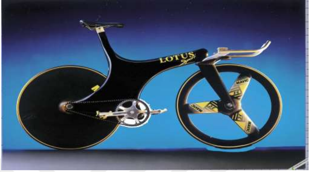
Şekil 9. Lotus Type marka bisiklet farklı pedal tasarımı, hava direncini azaltan, tek parça ve karbon lif dış yüzeyi ile uzun zaman sonra Britanya' ya madalya kazandıran aerodinamik bisiklet, 2016.
