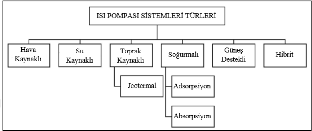
Şekil 3.4. Isı pompası sistemleri (Gaur, Fitiwi, & Curtis, 2021).
