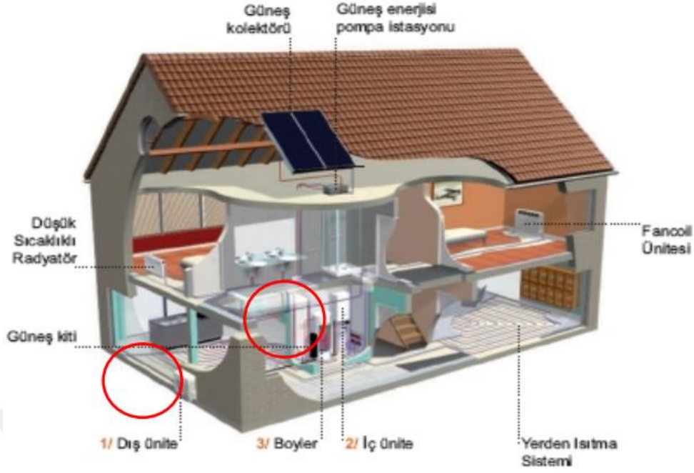
Şekil 3.5. Genel bir hava kaynaklı ısı pompası (Özyirmidokuz, 2010).
