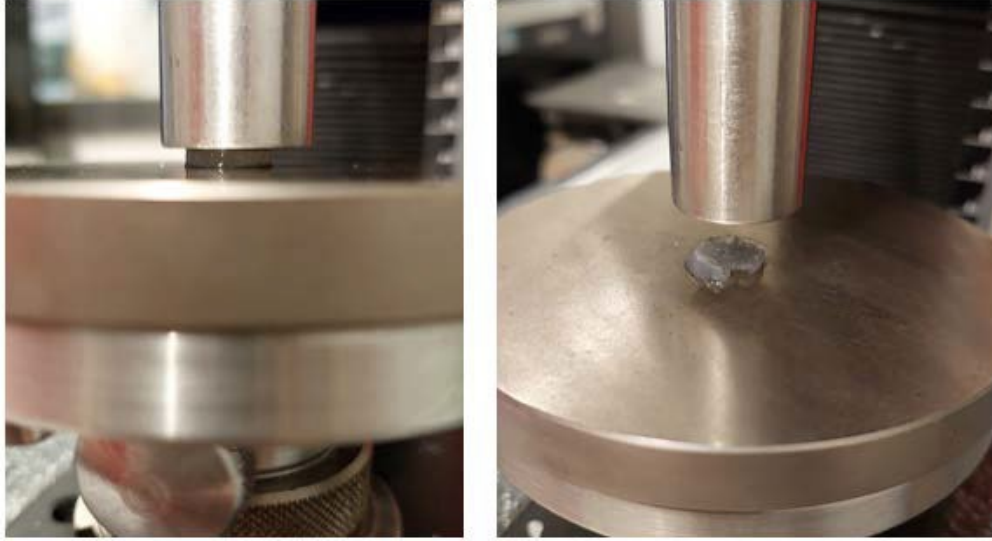
Şekil 4.9 AlgMA/HAMA hibrit hidrojenlerinin Zwick Roell 20.5 TH test cihazı ile sıkıştırma testi uygulama gösterimi.
