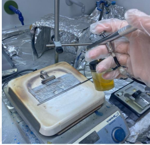
Şekil 3.2 Yoğun TiO 2 Çözeltisinin Püskürtme Yöntemiyle Kaplanması Kullanılan Düzenek
